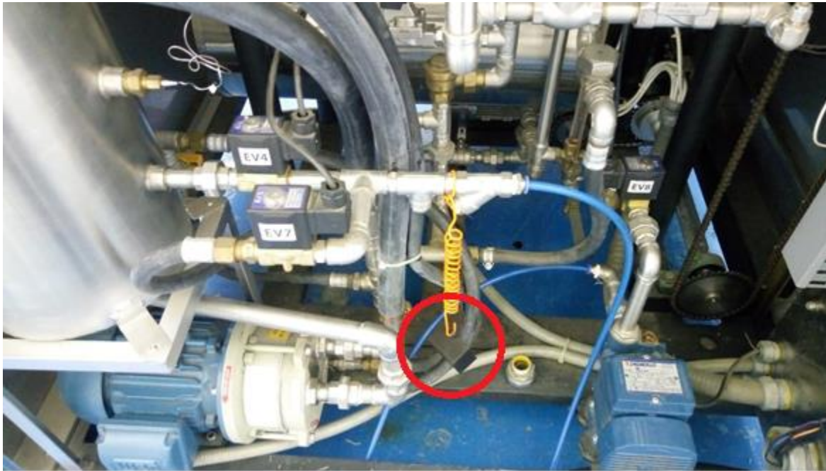
Figura 4. Montaje del micrófono de la máquina, el micrófono esta señalado con un círculo rojo.
