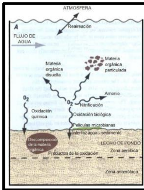
Figura 1. Ciclo del oxígeno disuelto en un cuerpo hídrico
