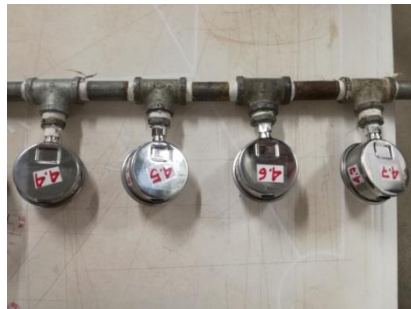
Figura 24. Marca realizada a manómetros calibrados.
