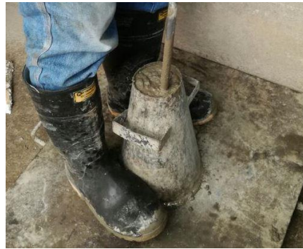
Figura 10. Compactación de capas.
