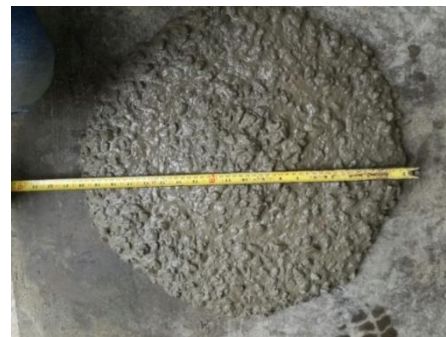
Figura 12. Asentamiento concreto autocompactante de 500 mm.
