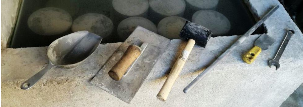
Figura 3. Herramientas pequeñas necesarias para la elaboración de cilindros. De izquierda a derecha: Cuchara, llana metálica, martillo de caucho, varilla de 5/8", espátula, llave
