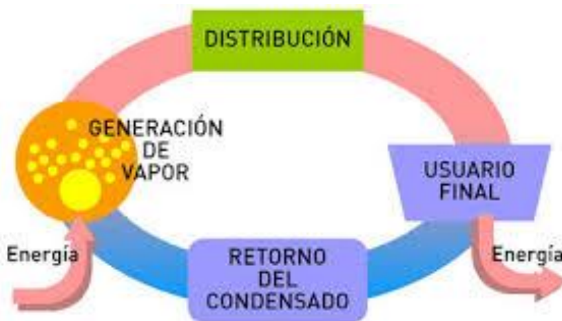
Figura 22. Diagrama del proceso de un sistema de generación de vapor.
