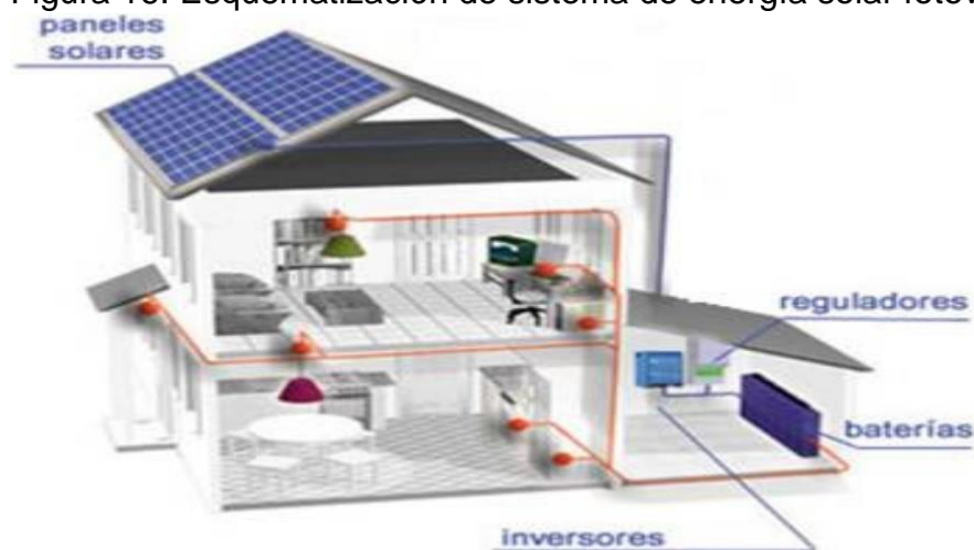
Figura 16: Esquematación de sistema de energía solar fotovoltaica.
