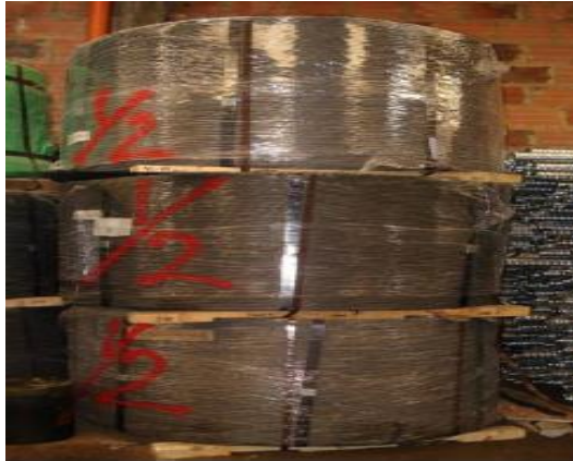
Figura 64: Cables de tensionamiento almacenados. (Stup Latinoamérica)
