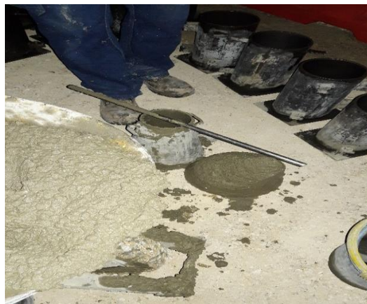
Figura 24: Ensayo slump. (Autor)
