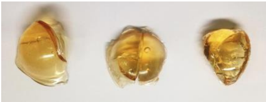
Figura 12. Restos fracturados de rotomoldeado a 8 rpm en un molde totalmente esférico. El resultado son fracturas de la forma que no logro secarse al tener un molde totalmente cerrado.
