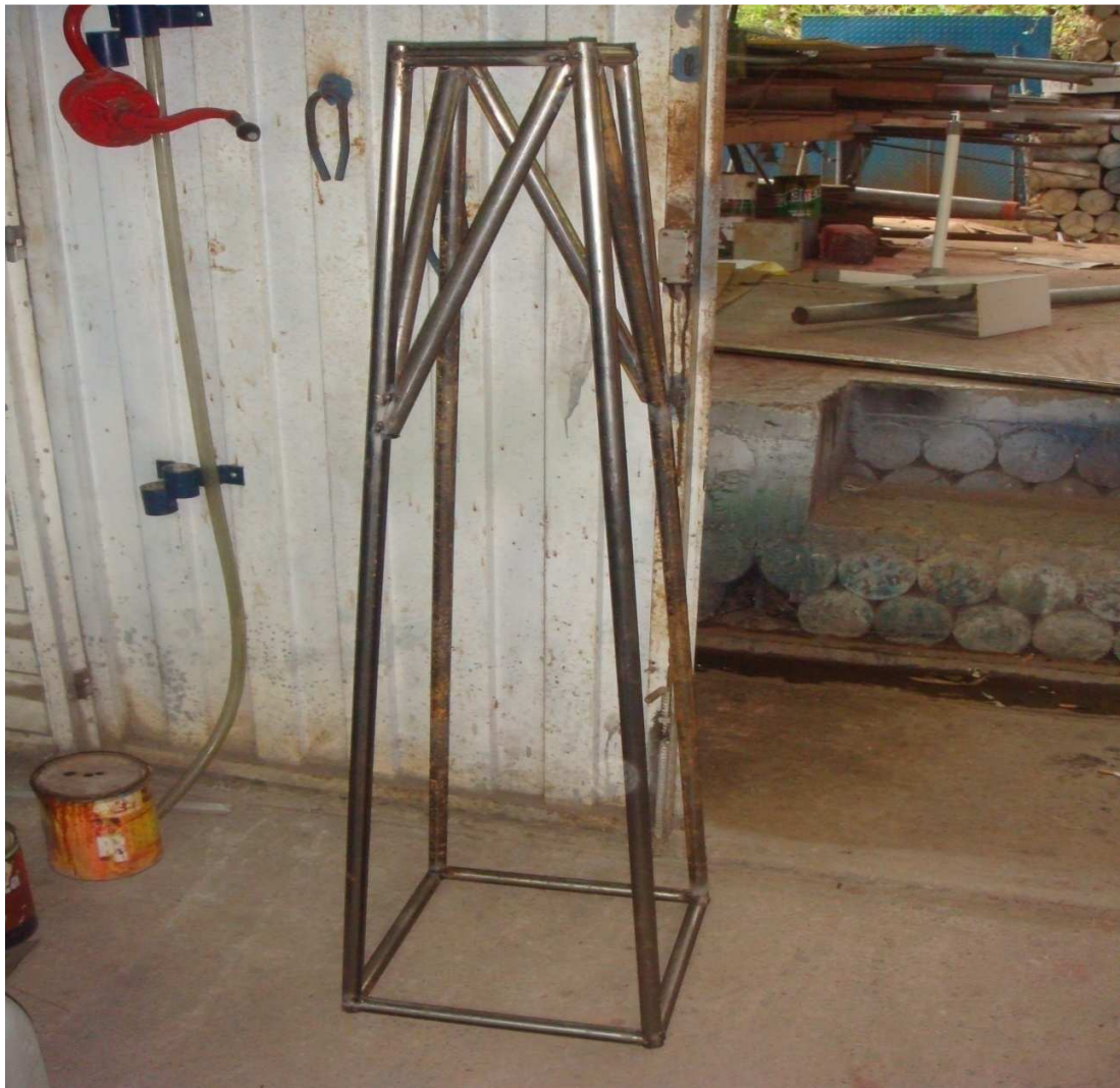
Figura 13 Construcción de la torre
