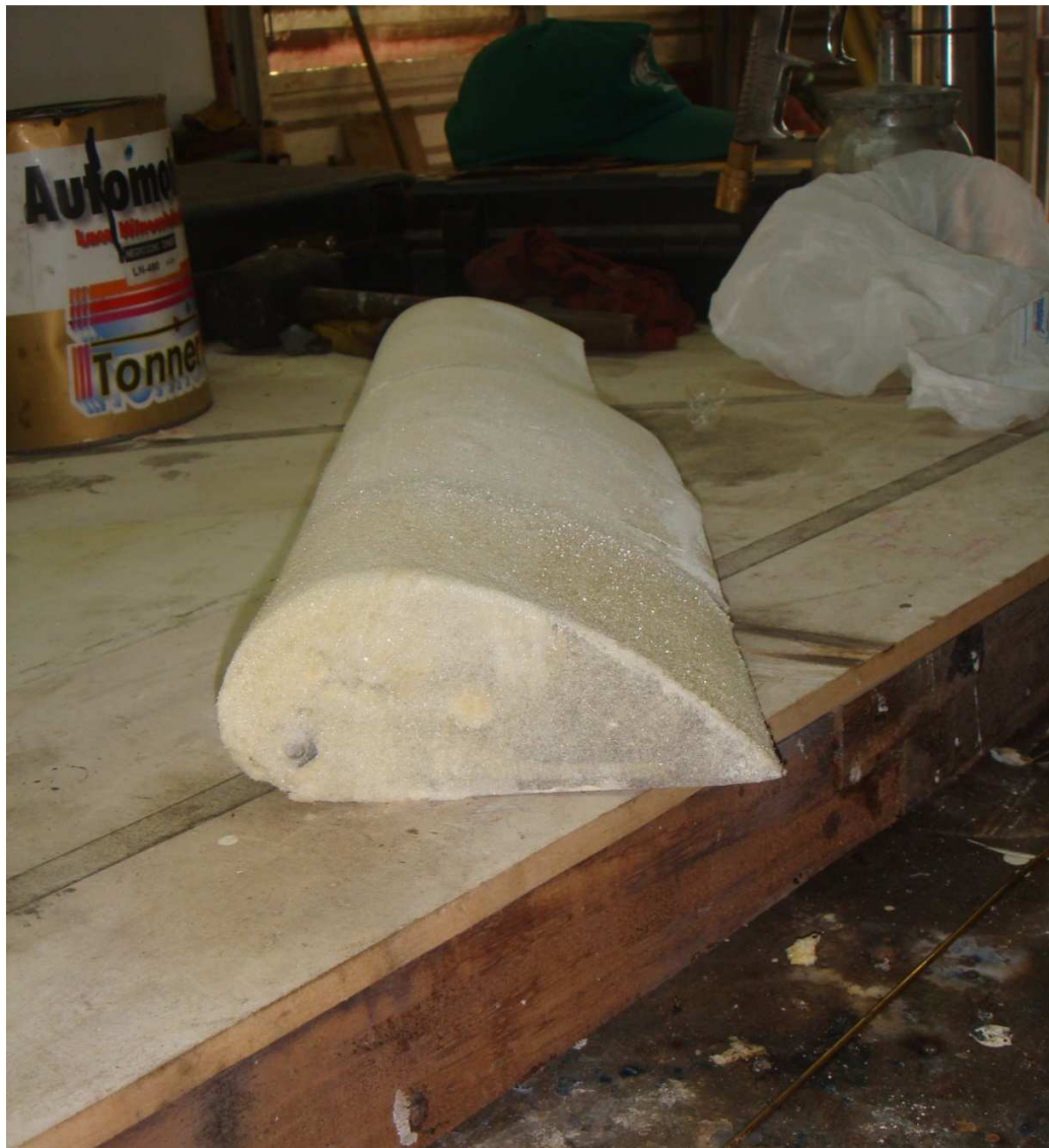
Figura 41 Perfil De Ala Recubierto Con Poliuretano
