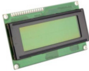
Figura 10: Pantalla LCD HD44780U
