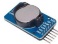
Figura 15: Reloj en tiempo real DS3231
