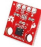
Figura 11: Sensor de humedad relativa y temperatura HTU21D
