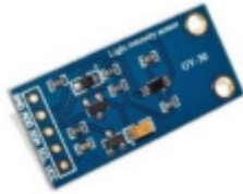
Figura 12: Sensor de luz BH1750
