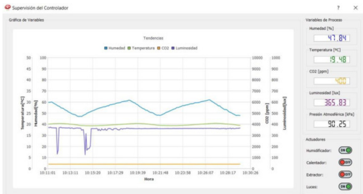
Figura 60: Interfaz de gráficas en tiempo real de la aplicación Shiitake V1.0 – Control manual de humedad
