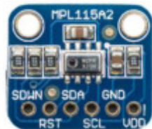
Figura 14: Sensor de presión MPL115A2
