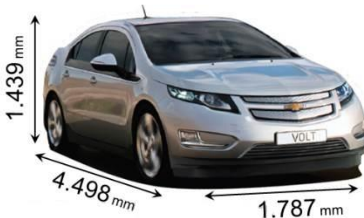
Ilustración 13. Dimensiones Chevrolet Volt.
