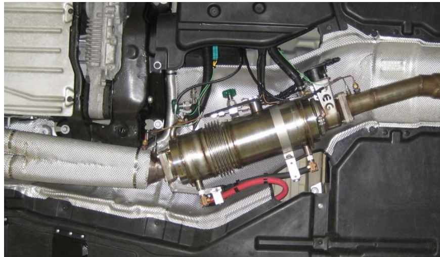
Ilustración 23. Generadores termo-eléctricos implementados en vehículos. a).Esquema de montaje del generador termo eléctrico.
