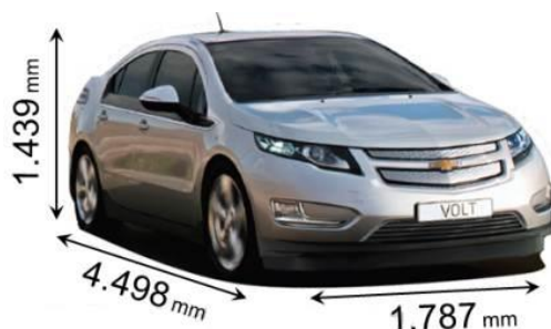
Ilustración 5. Dimensiones Chevrolet Volt
