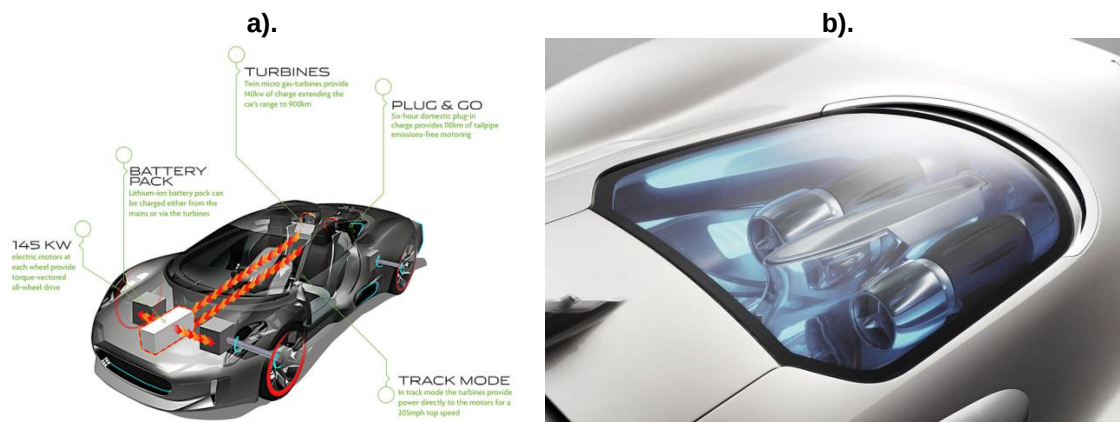
Ilustración 7. Jaguar C-X75: a). Distribución de sistemas. b). Micro turbinas de generación.
