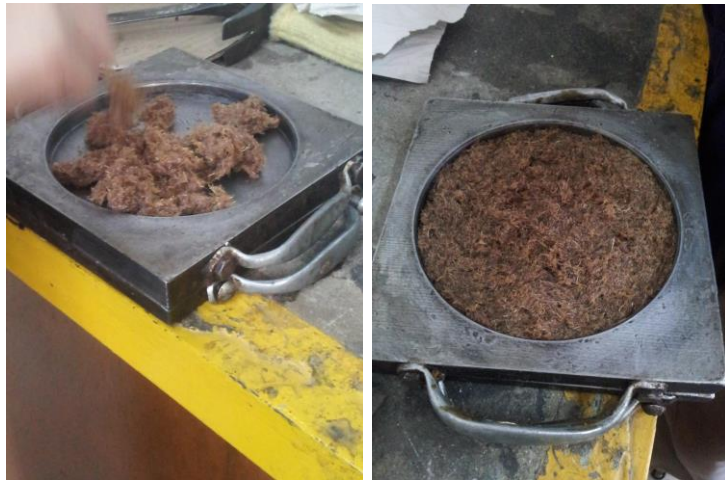
Figura 16: Agregado del mezclado 2 en el molde.
