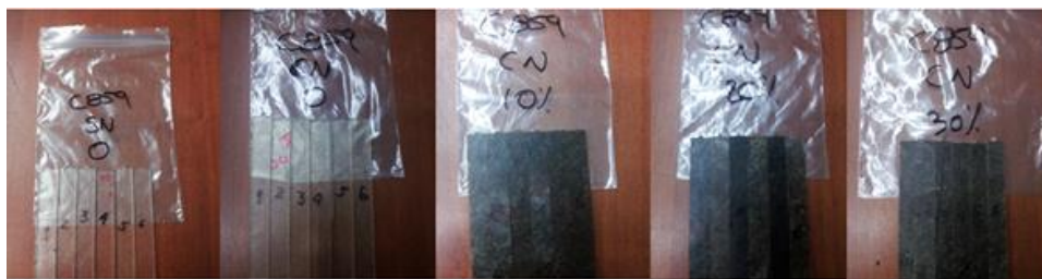
Figura 20: Probetas para ensayo de flexión después del corte.
