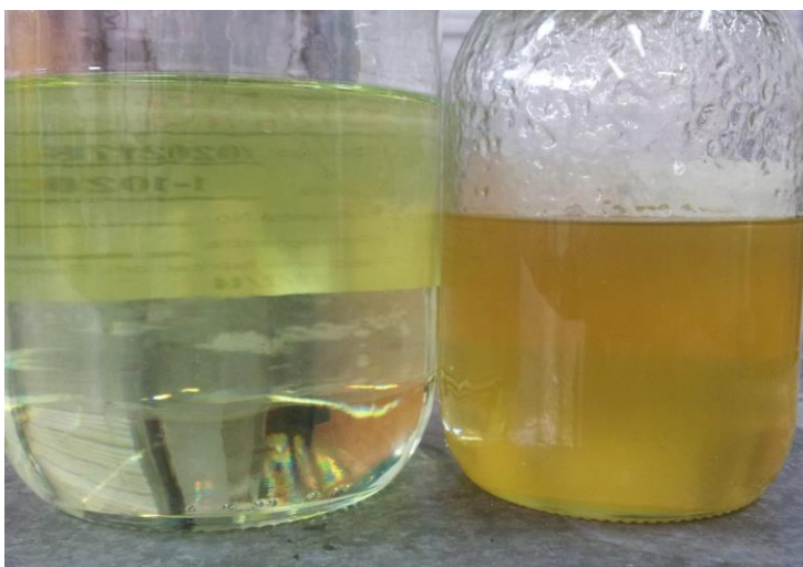
Figura 2: A la izquierda resina CRYSTALAN CH859, a la derecha CRYSTALAN CH859 con nanofibrillas de celulosa bacteriana.
