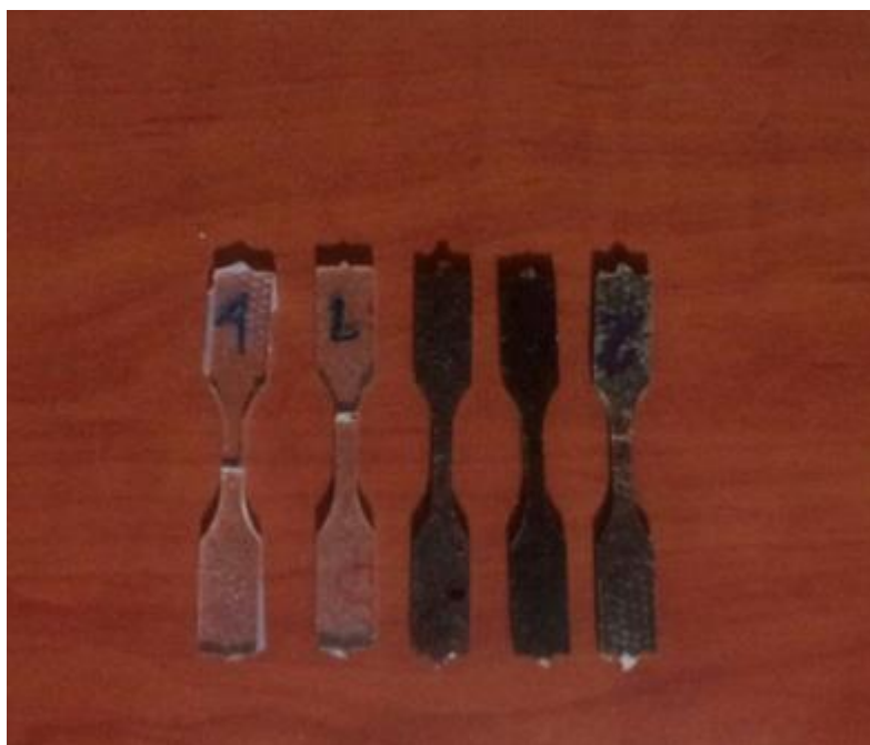
Figura 21: Probetas para ensayo de tracción después del corte.
