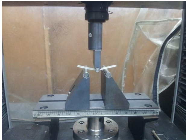
Figura 23: Probeta en ensayo de flexión.
