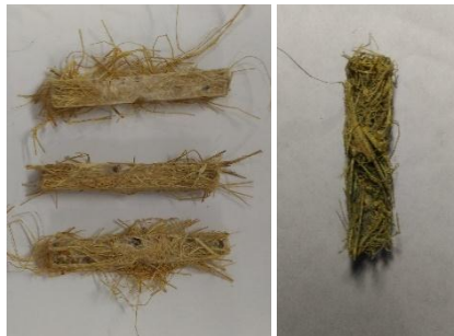
Figura 7. Probetas de impacto ASTM D638 de diferentes micelios. A la izquierda micelio de la Universidad de Antioquia, a la derecha micelio de Setas de Siecha. Fotografía por Laura Gallego
