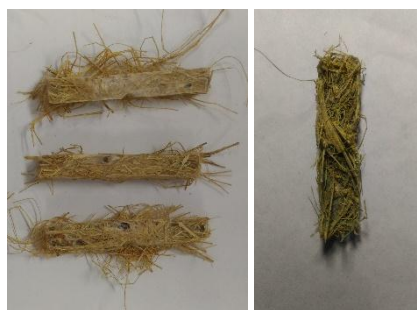
Figura 8 Probetas de impacto ASTM D638 de diferentes micelios. A la izquierda micelio de la Universidad de Antioquia, a la derecha micelio de Setas de Siecha. Fotografía por Laura Gallego
