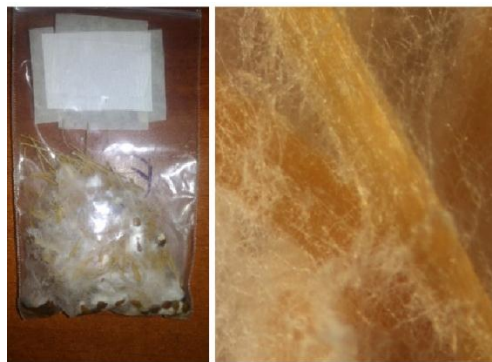
Figura 6. Ensayo elegido para ser replicado. (IZQ) Proceso de incubación pasadas 96 h (DER) Crecimiento de las hifas sobre la fibra. Fotografía tomada con un estereomicroscopio Olympus SZ-PT , por Laura Gallego
