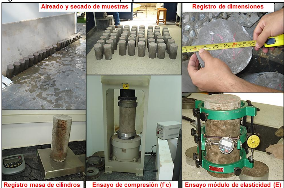
Figura 21. Determinación de las propiedades del concreto endurecido
