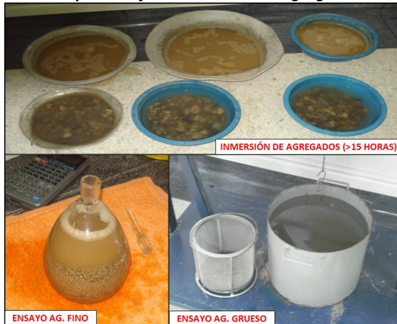
Figura 8. Gravedad específica y absorción de los agregados
