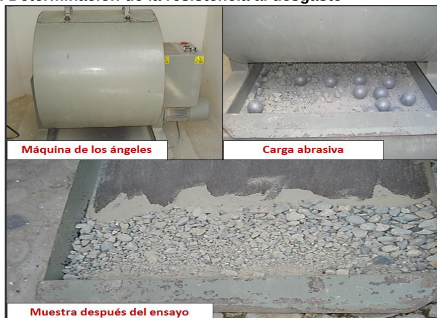
Figura 11. Determinación de la resistencia al desgaste
