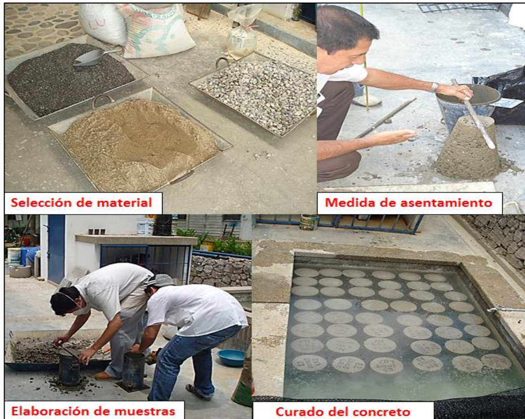
Figura 13. Elaboración y curado de muestras de concreto para ensayos de laboratorio
