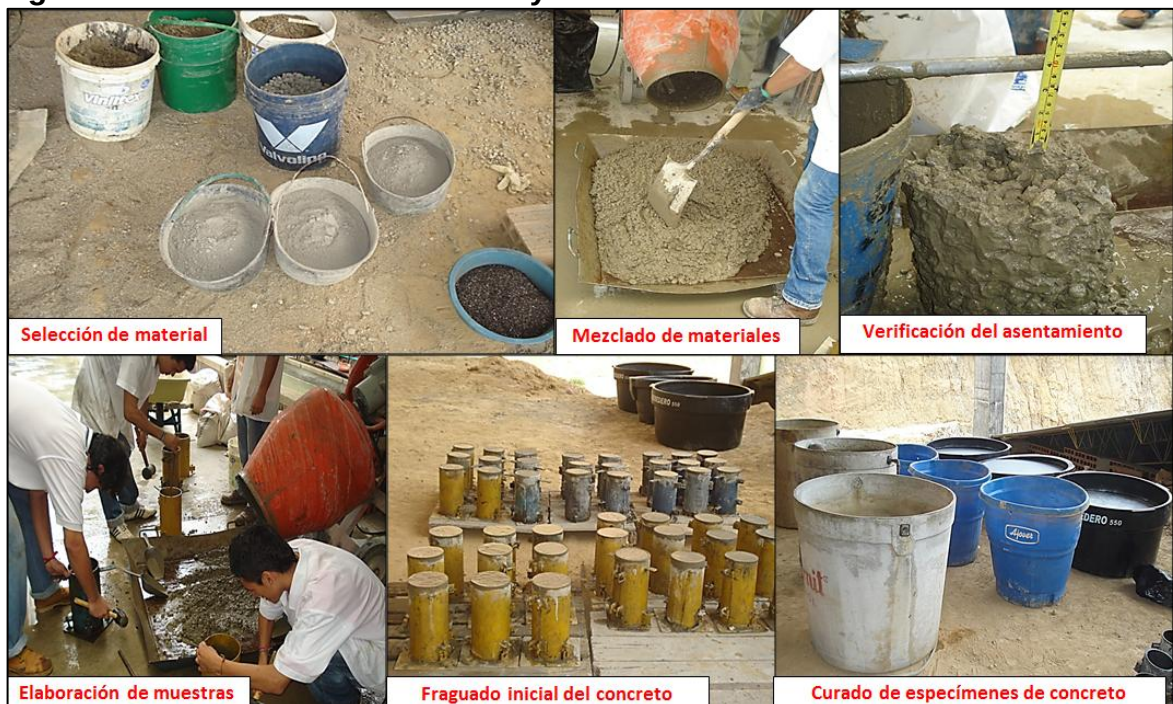
Figura 19. Proceso de elaboración y curado de cilindros de concreto
