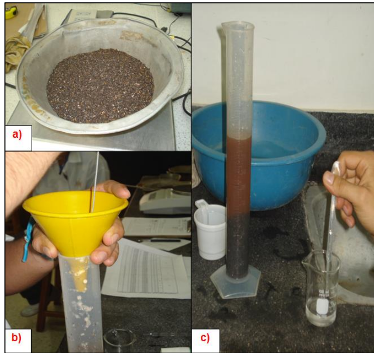
Figura 7. Estimación densidad de la limalla
