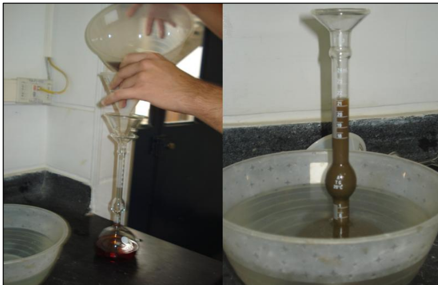
Figura 6. Densidad del cemento hidráulico
