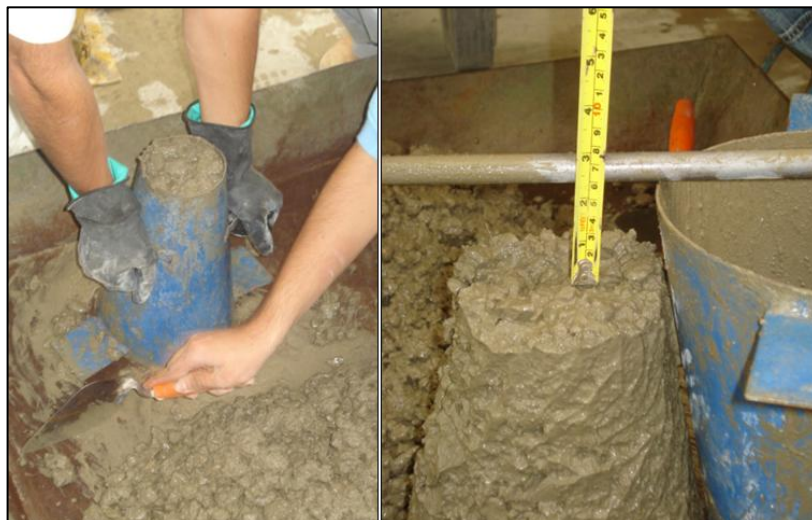
Figura 1. Asentamiento del concreto
