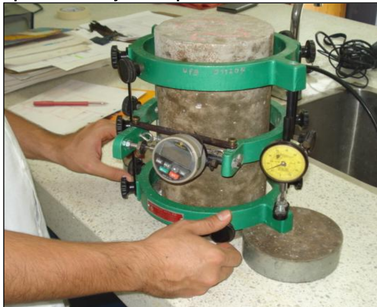
Figura 14. Compresómetro ajustado para medida del modulo de elasticidad
