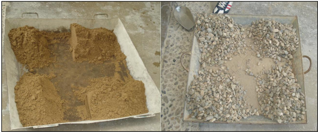
Figura 5. Cuarteo de material
