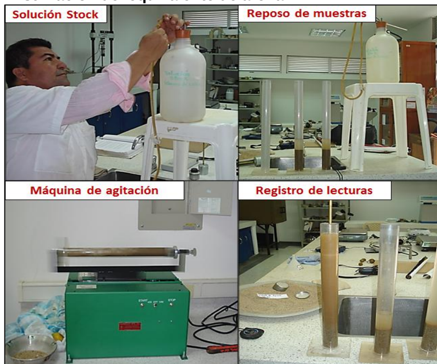
Figura 12. Estimación del equivalente de arena
