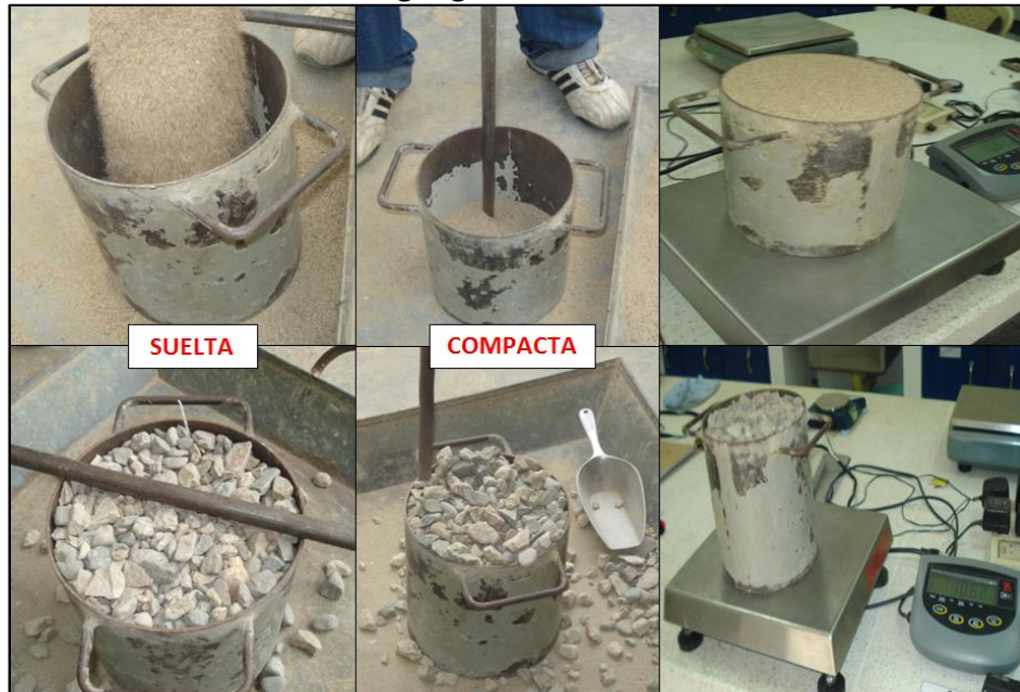
Figura 9. Masa unitaria de los agregados
