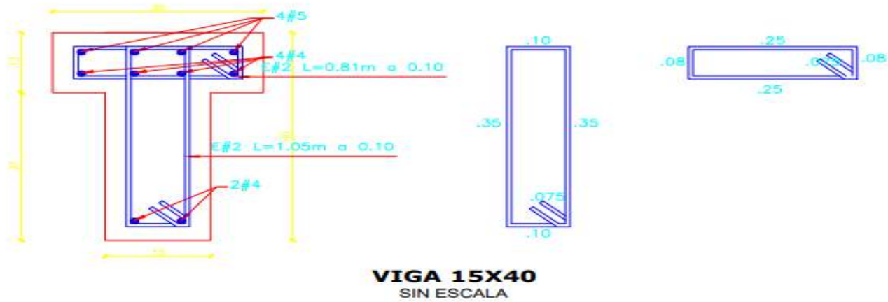
Figura 36. Detalle Viga T 15X40 (Construca, 2021)
