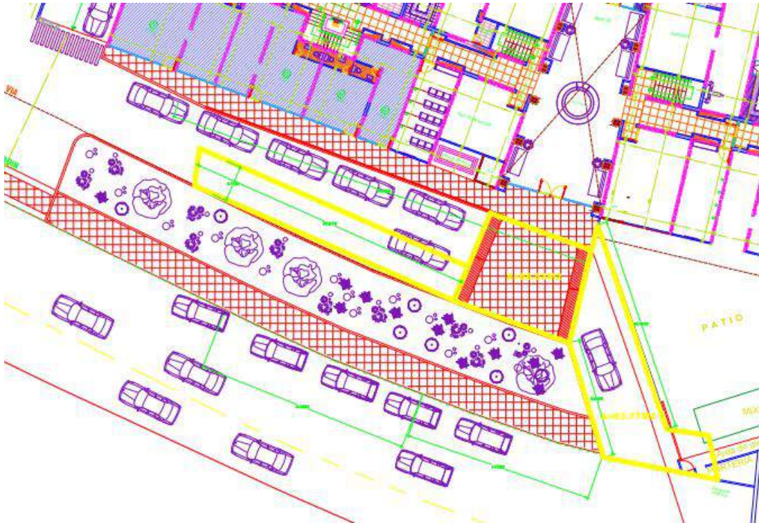
Figura 8. Plano acceso vehicular (Construcasa, 2021)
