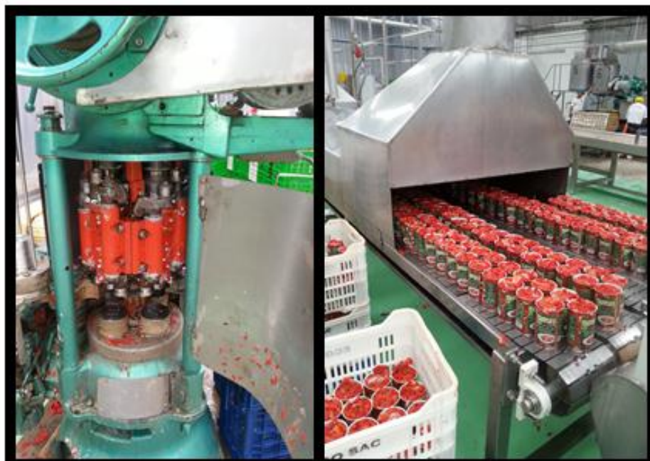
Figura 17. Estado y consecuencias del mal funcionamiento en máquinas de cerrado. Fuente: Autor del proyecto.
