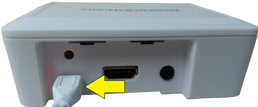
Fig. 8. Adaptador de energía conectado al puerto de alimentación.
