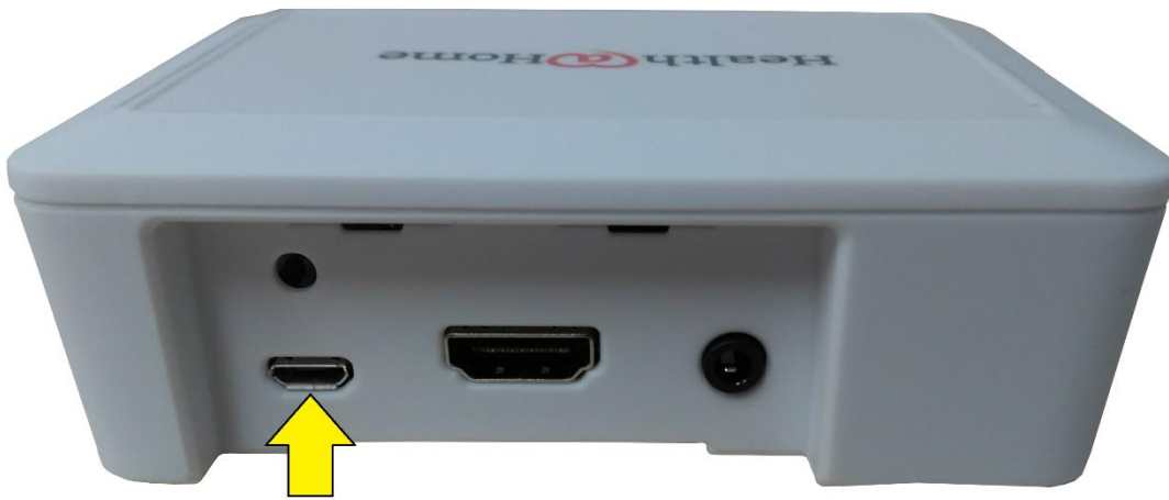
Fig. 7. La flecha amarilla indica la ubicación del puerto de alimentación.
