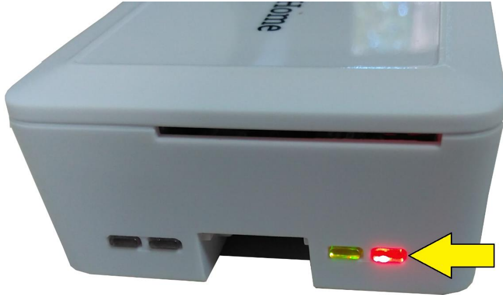
Fig. 9. El led de color rojo indica que el HUB se encuentra encendido.
