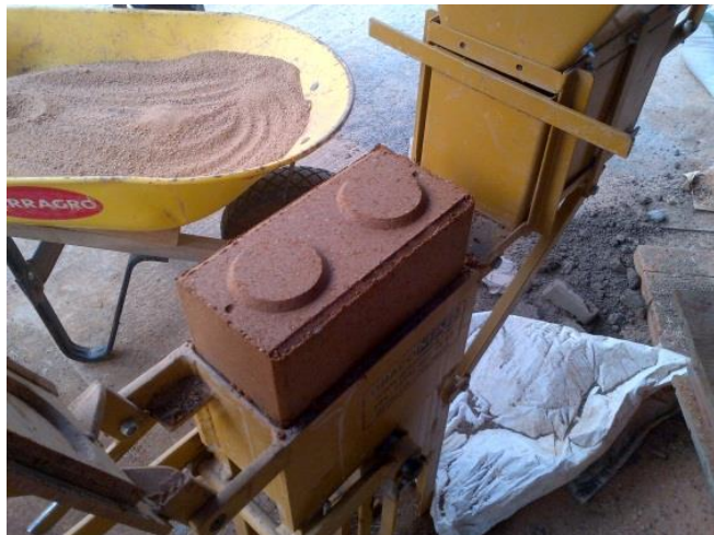
Figura 30. Mampuesto de suelo cemento
