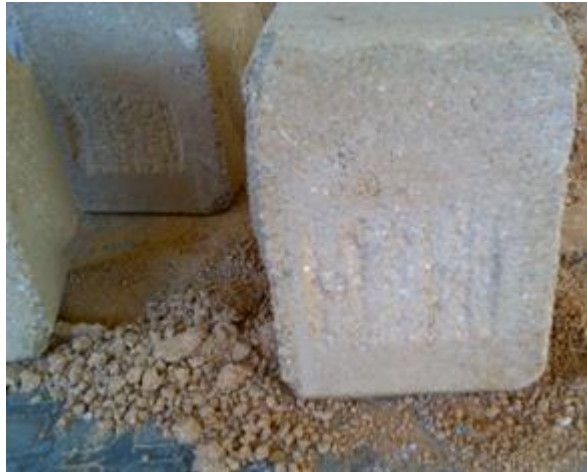
Figura 45. Huella producida por el ensayo de desgaste
