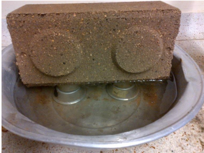
Figura 47. Fin del ensayo de absorción, bloque de suelo + ceniza 5% (10 min)
