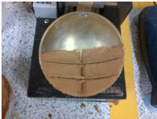
Figura 8. Porción de suelo después de cerrada la ranura
