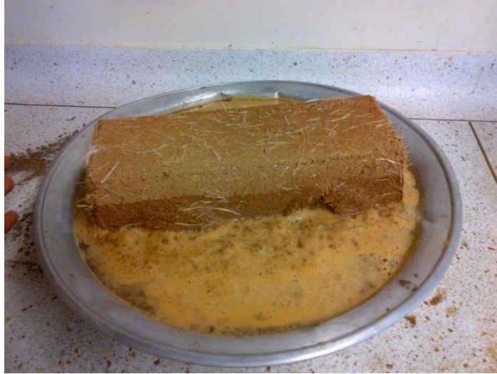
Figura 48. Destrucción del bloque 0,5% de fibra
