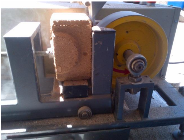
Figura 19. Ejecución del ensayo de desgaste
