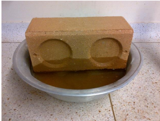
Figura 46. Fin del ensayo de absorción bloque de suelo + cemento 5% (10 min)
