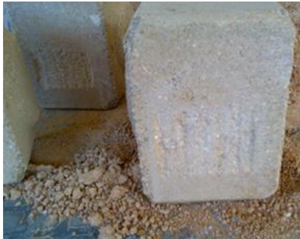
Figura 40. Huella de ensayo de abrasión
