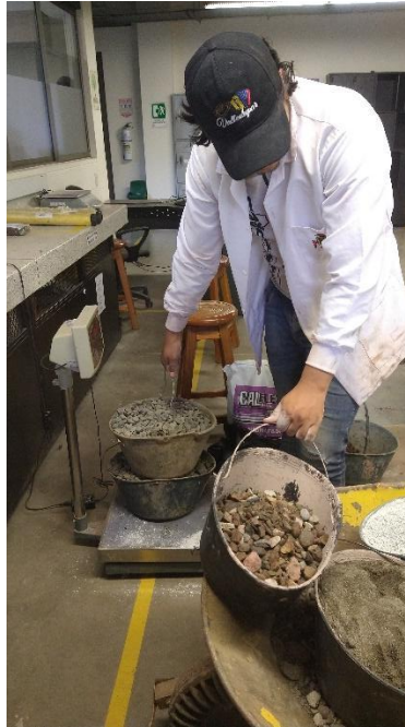
Figura 2. Pesaje de materiales
