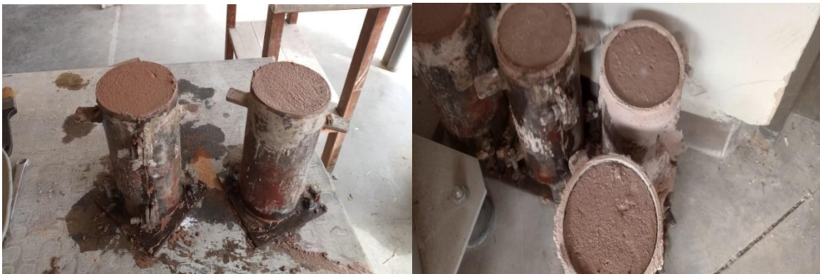
Figura 5. Creación y enrasamiento de cilindros A - B
