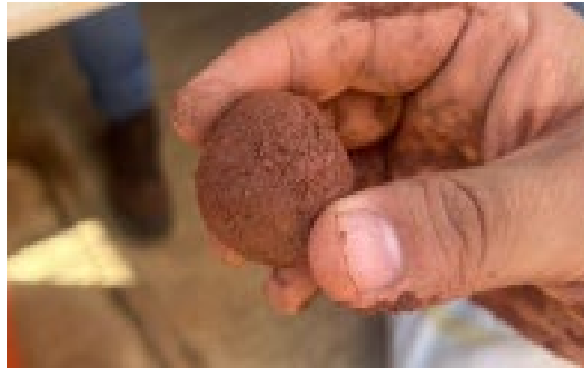
Figura 20. Test de caída de bola
