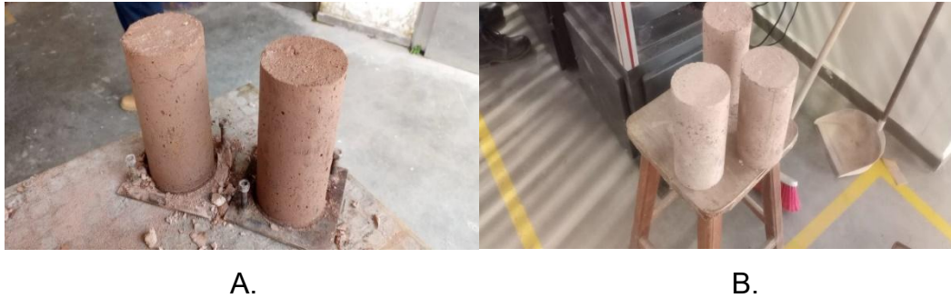
Figura 6. Extracción de las muestras de los cilindros A. -B.
