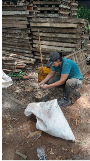
Figura 16. Separación de fibras de bagazo
