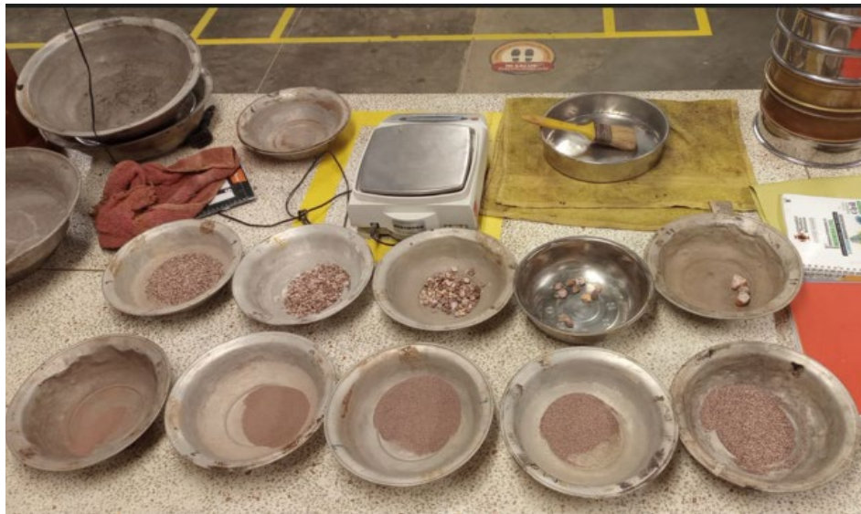
Figura 23.Registro fotográfico Ensayo de Granulometría
