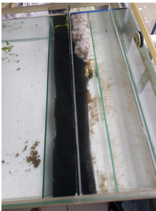
Gráfica 25: Instalación de materiales filtrantes (mecánicos)
