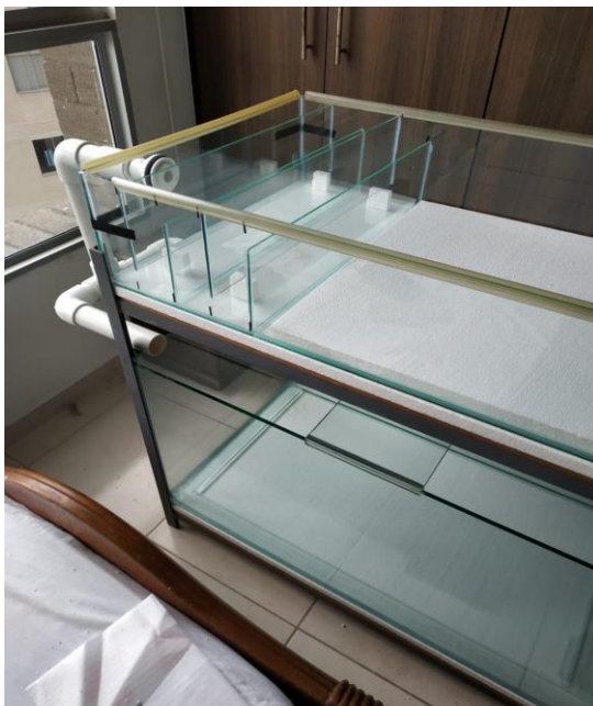
Gráfica 20: Instalación de tubería y protección final anti cortes
