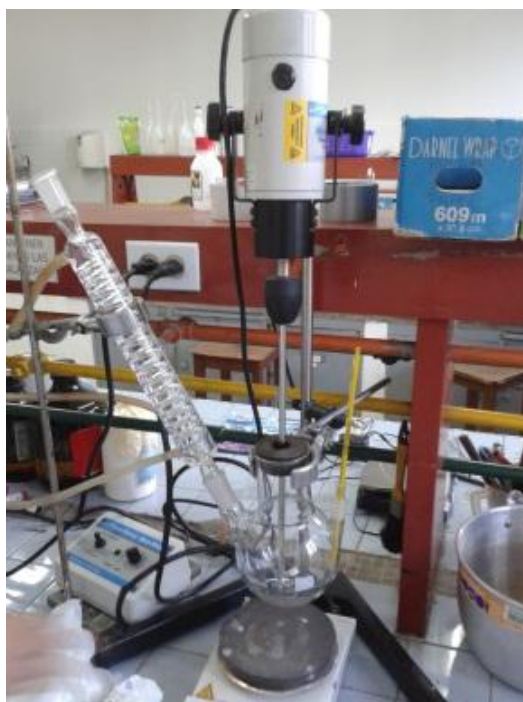
Figura 7. Esquema montaje para la síntesis de xerogeles de microesferas de carbono
