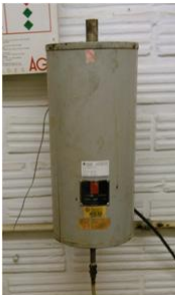
Figura 8. Horno tubular para el proceso de carbonización y activación térmica.
