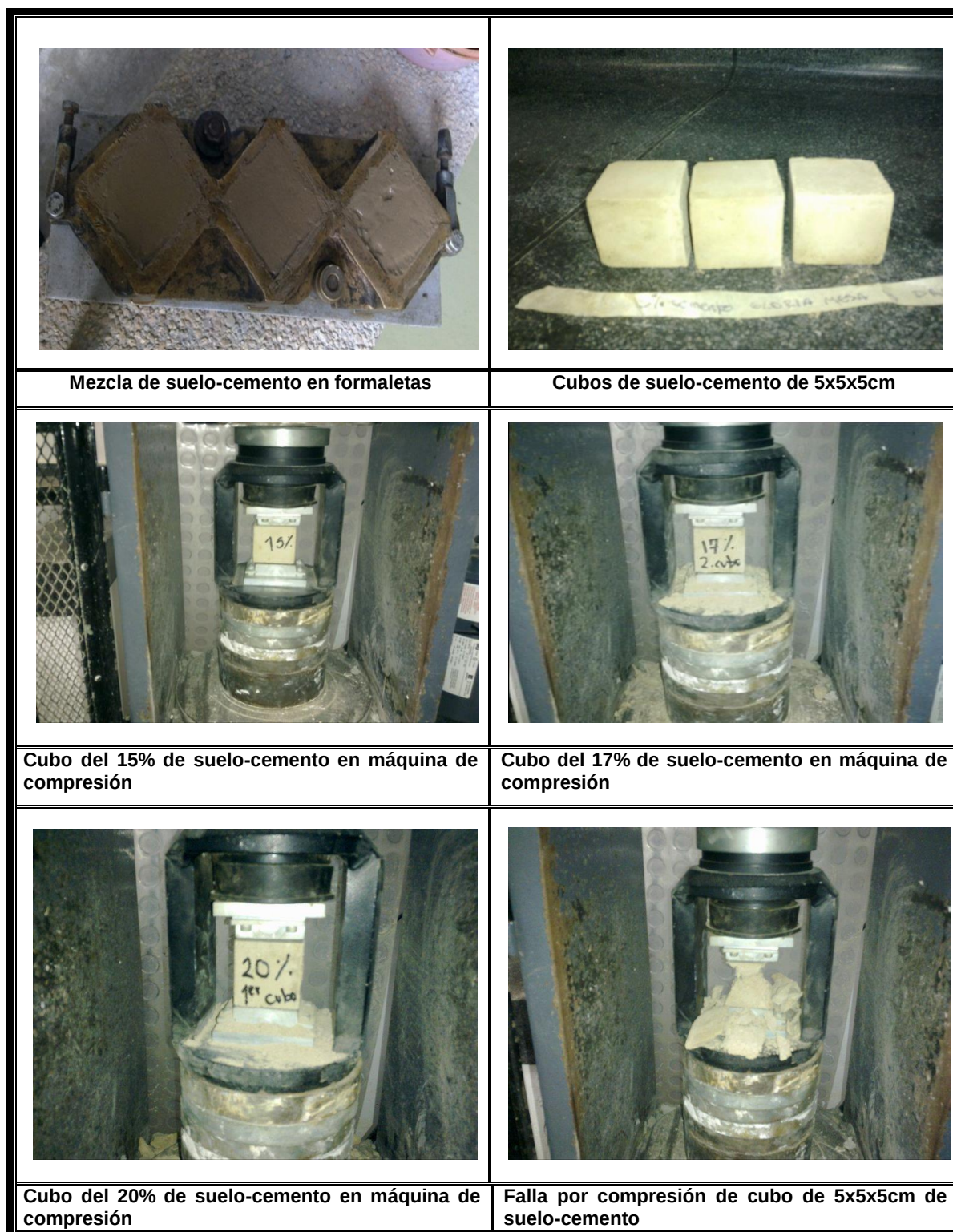
Figura 17. Procedimiento Fotográfico Elaboración de Muestras Material Aglomerante.
