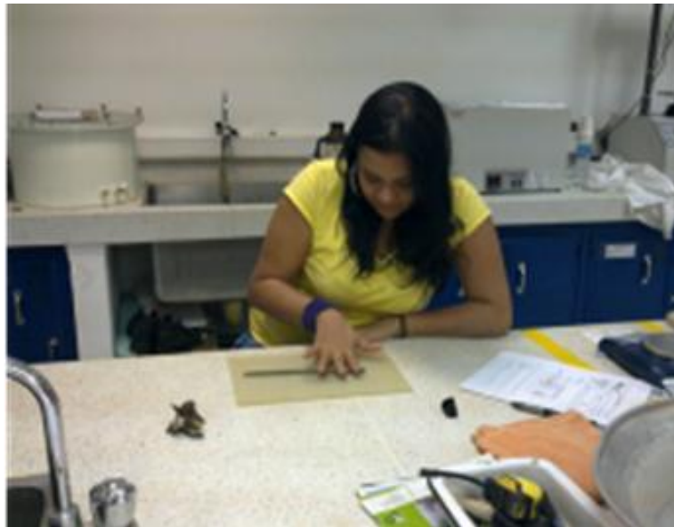
Figura 12. Realización de Muestras para el Límite Plástico.
