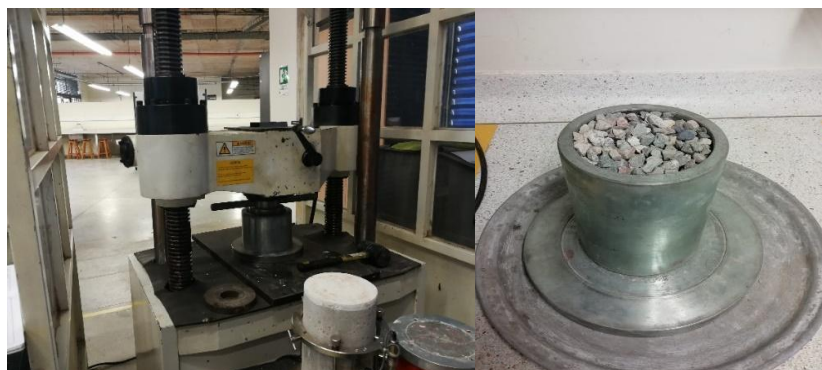
Fotografía 4. Ensayo 10% de Finos
