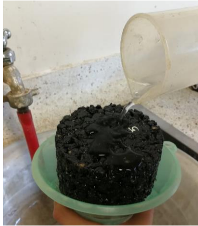
Fotografía 26. Prueba de permeabilidad
