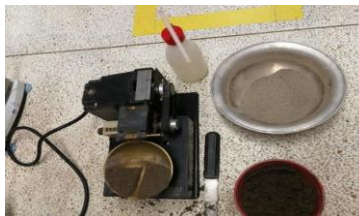
Fotografía 6. Ensayo para hallar el índice de plasticidad
