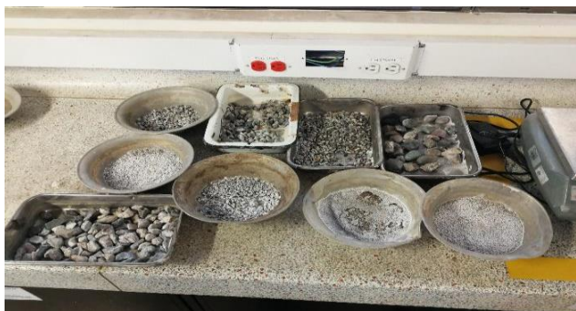
Fotografía 5. Muestras del ensayo de solidez
