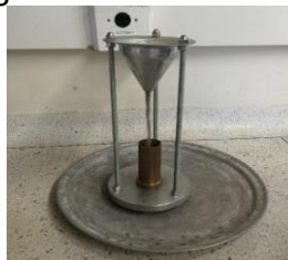
Fotografía 9. Ensayo de angularidad
