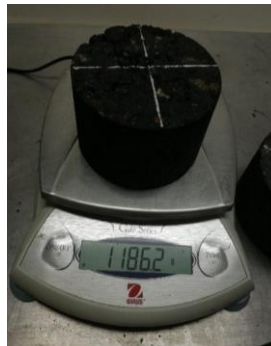
Fotografía 20. Peso muestra seca en el aire.
