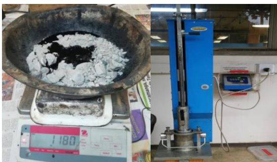
Fotografía 18. Mezclado y compactación de las mezclas
