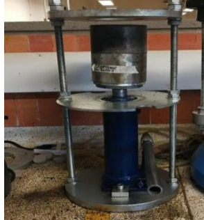
Fotografía 19. Extracción de probetas.
