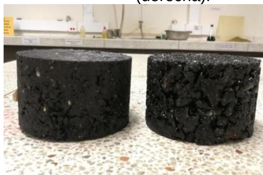
Fotografía 23. Comparación muestra convencional (izquierda) y drenante (derecha).
