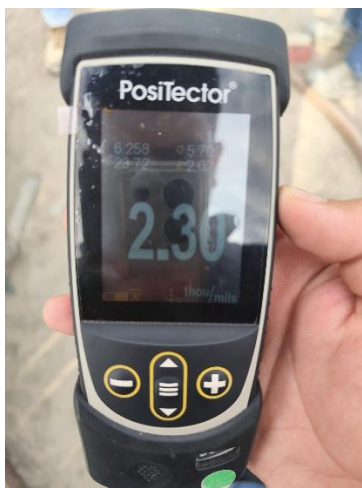
Fig. 7 Toma de datos en actividades santblasting
