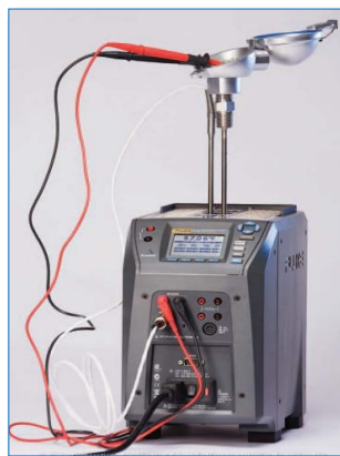
Figura 12 bloque seco fluke 8
