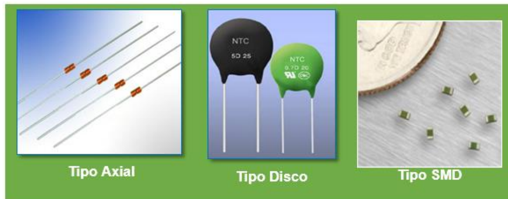
Figura 5. Configuraciones de los termistores. 3
