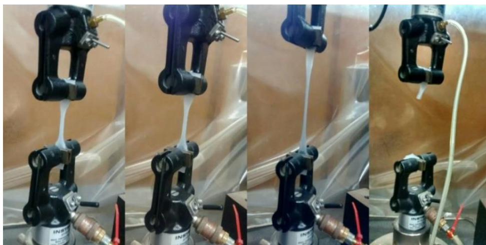
Figura 12. Ensayos mecánicos de tracción basados en la norma ASTM D638.
