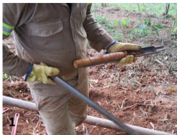
1. Introducción de la tubería. 2. Conteo número de golpes. 3. Extracción de la tubería. 4. Apertura de la cuchara partida SPT
