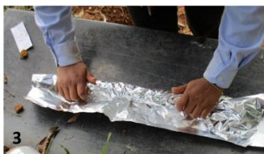
1. Muestra recuperada en tubo SPT. 2. Análisis, medida y tipificación. 3 y 4. Muestra embalada. 5. Caja guarda muestras para envío a laboratorio.
