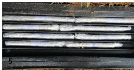
1. Muestra recuperada en tubo SPT. 2. Análisis, medida y tipificación. 3 y 4. Muestra embalada. 5. Caja guarda muestras para envío a laboratorio.
