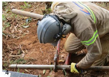
1. Introducción de la tubería. 2. Conteo número de golpes. 3. Extracción de la tubería. 4. Apertura de la cuchara partida SPT
