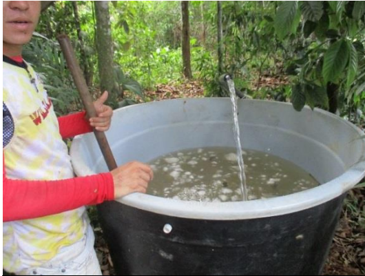
Figura No. 30: Llenado de tanque de agua con Polímeros
