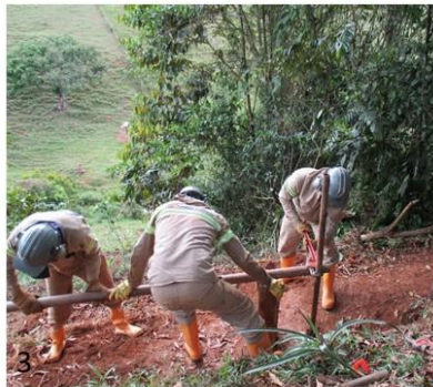
1. Introducción de la tubería. 2. Conteo número de golpes. 3. Extracción de la tubería. 4. Apertura de la cuchara partida SPT
