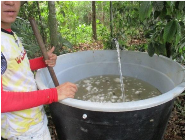
Figura No. 39: Llenado de tanque de agua con Polímeros
