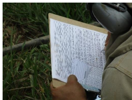
Figura No. 22: Registro de # Golpes, profundidad, % de recuperación y descripción de la muestra
