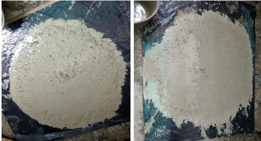
Figura 45. A la izquierda, no conformidad 020: concreto de 56 MPa con flujo de 790 mm. A la derecha, no conformidad 021: concreto de 56 MPa con flujo de 850 mm
