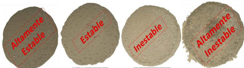
Figura 41. Asentamientos en concretos autocompactantes
