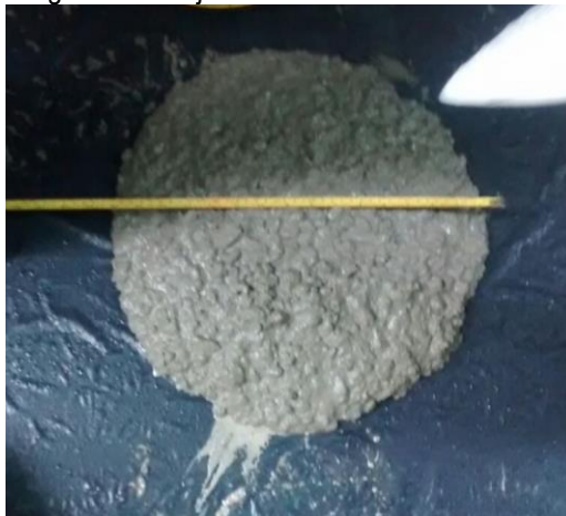
Figura 50. Flujo libre en concreto de 49 MPa
