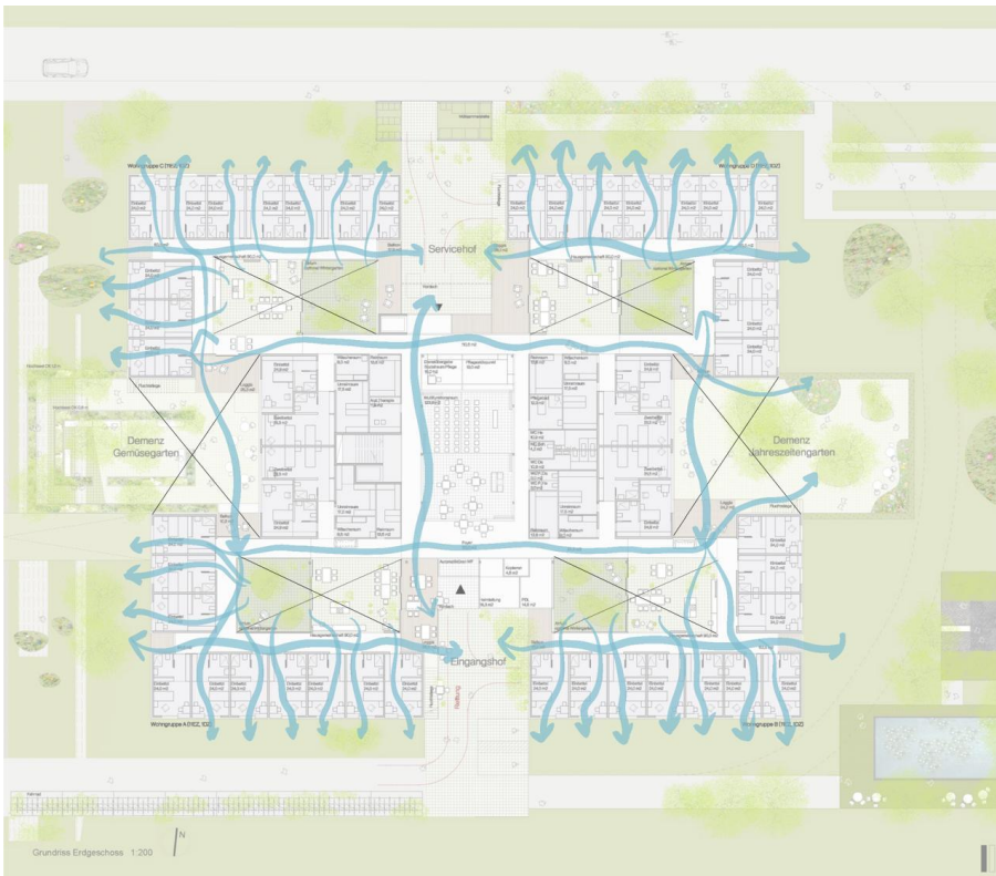
Imagen 42. Plano intervenido que muestra la ventilación cruzada en el proyecto. Plano realizado por Dietger Wissounig Architekten e intervenido por autora.
