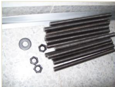
Figura 23. Pernos de \frac{3}{4} " de Acero - rosca ordinaria.
