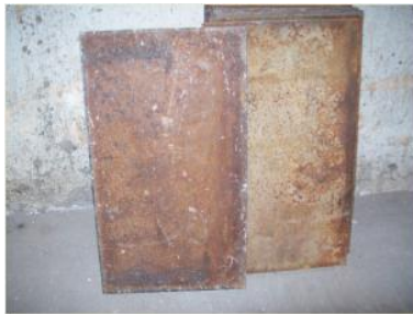
Figura 24. Platinas de Acero de \frac{3}{8} ".
