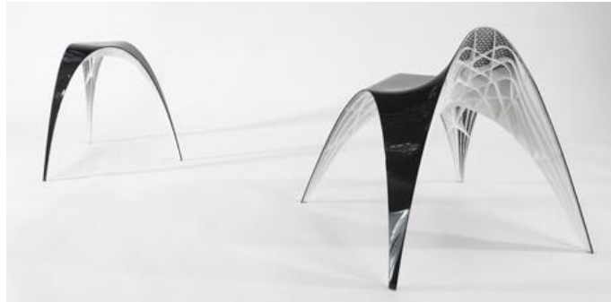
Ilustración 93: Basada en el sistema de Gaudí de colgar cadenas. La superficie es en fibra de carbono y las costillas en nailon reforzado con fibra de vidrio ambos fabricados por sinterizado láser selectivo 75 .
