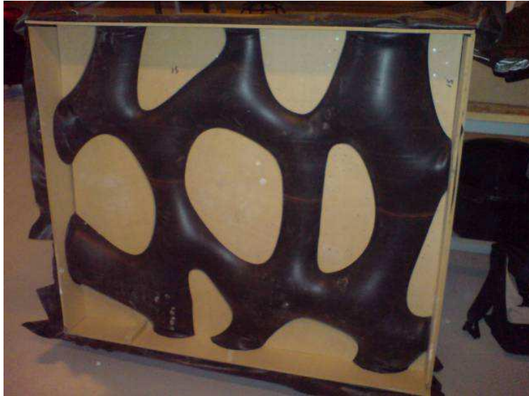
Ilustración 50: Mould of façade element
