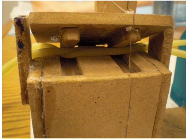
Figura 21. Válvula creada de doble estrangulamiento.
