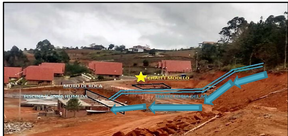
Ilustración 33 – Esquema Trayectoria del Agua.
