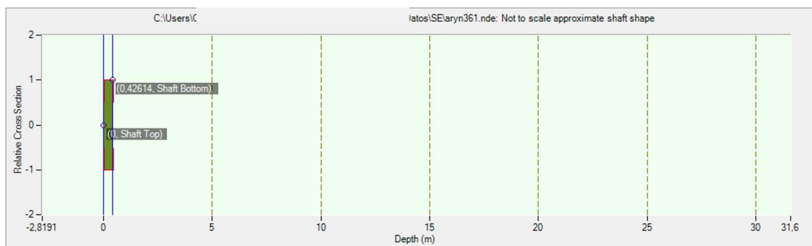
Figura 21: Simulación de sección transversal relativa basado en onda de transmisión en software WinIE, ensayo Impact Echo
