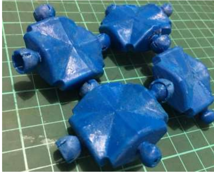
Figura 11. Módulos juntos generando flexibilidad a partir de su mecanismo de rotación, material: ABS. Fuente: Autoría propia
