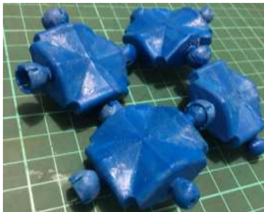
Figura 3. Módulos juntos generando flexibilidad a partir de su mecanismo de rotación, material: ABS. Fuente: Autoría propia
