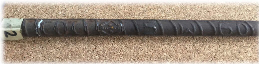
Fotografía 8. Marca de varillas de acero ensayadas.
