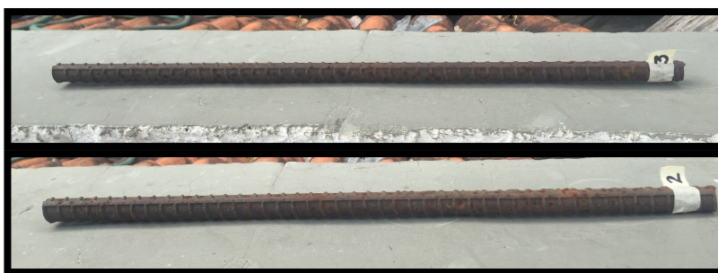
Fotografía 5. Varillas de ensayo a tracción 1y 4
