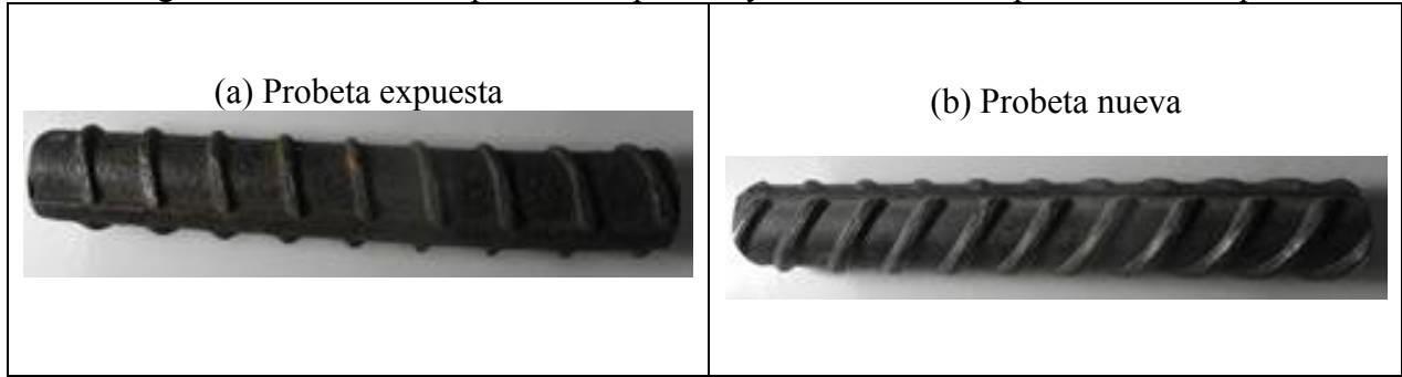
Fotografía 9 Estado de las probetas expuestas y nuevas antes del proceso de decapado.
