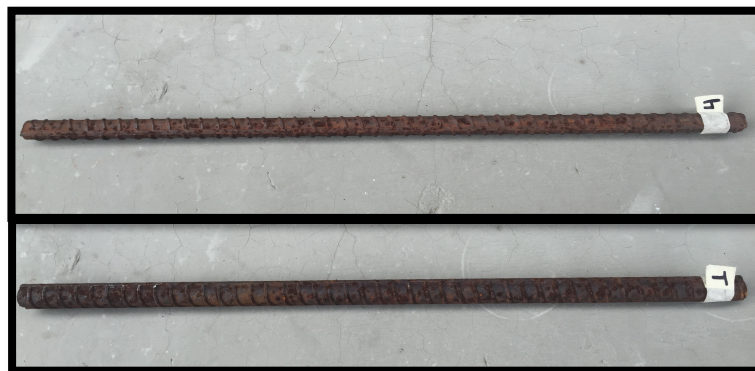
Fotografía 4. Varillas de ensayo a tracción 2 y 3
