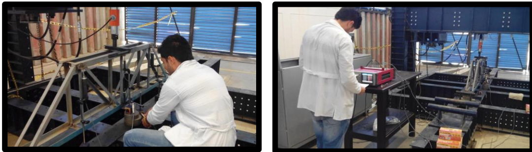
Figura 6. Montaje de la Cercha de acero en el laboratorio, medidas de deflexiones.
