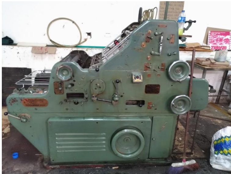
Imagen 19 Máquina troqueladora semiautomática marca Nebiolo vista lateral
