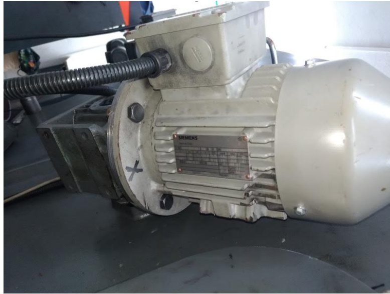
Imagen 4 Motor de 1 hp de la marca Siemens
