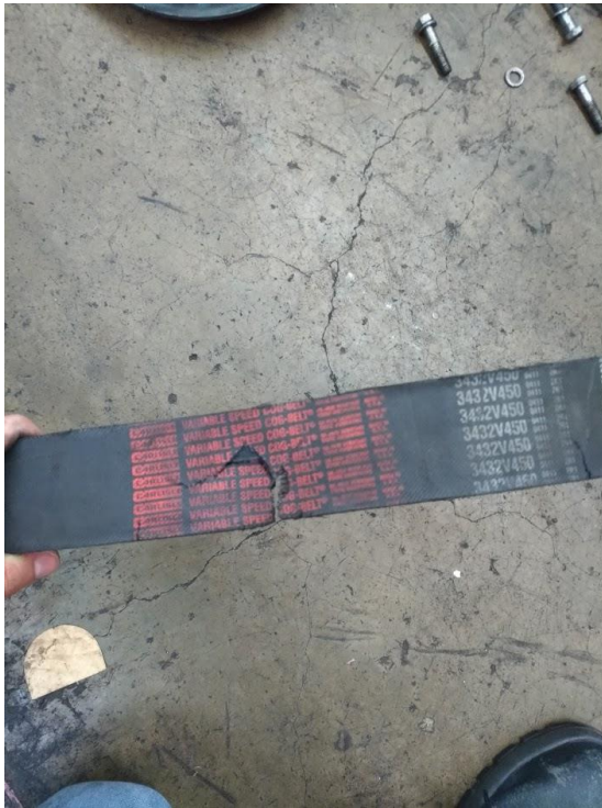
Imagen 13 Correa dentada desgastada referencia 3432V450
