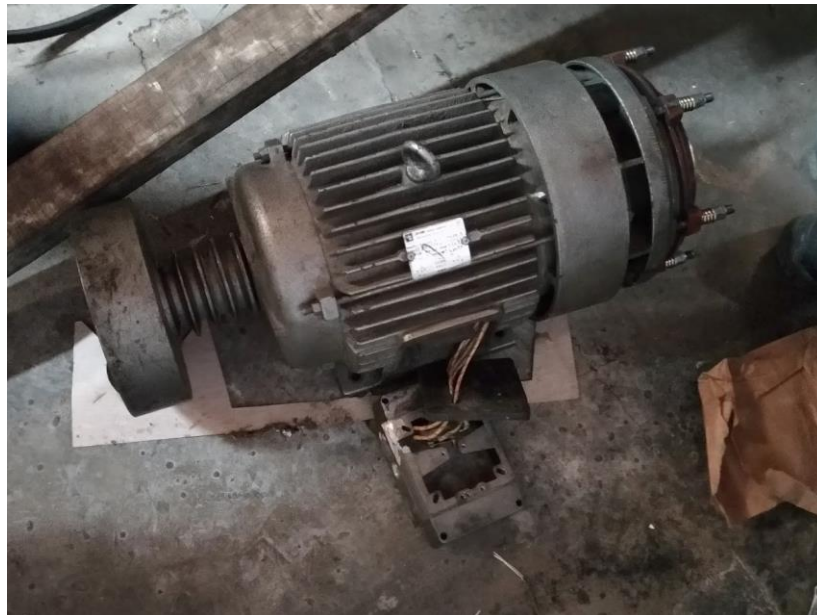
Imagen 11 Motor eléctrico de 5,5 kW marca MGM
