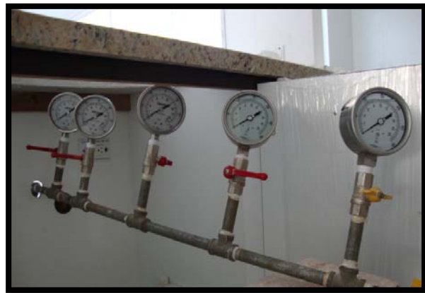
Foto 13, Manómetros para prueba hidráulica en calibración. Fuente Propia
