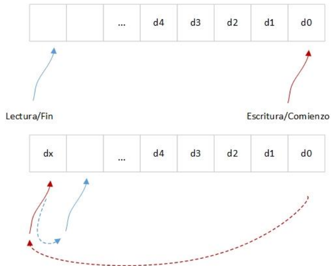
Figura 18. Movimiento de punteros en un buffer circular
