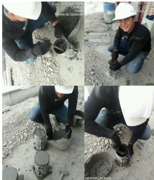
FOTOGRAFÍA 25 Elaboración de Cilindros
