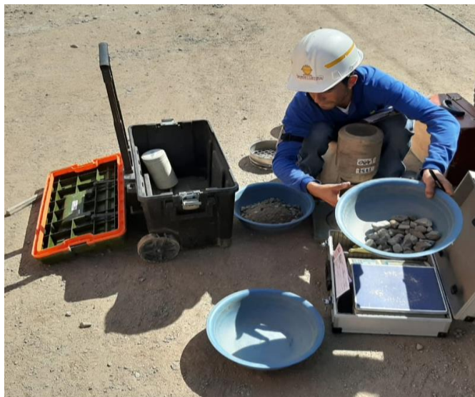
FOTOGRAFÍA 27 Toma de Muestras de Densidades de Campo
