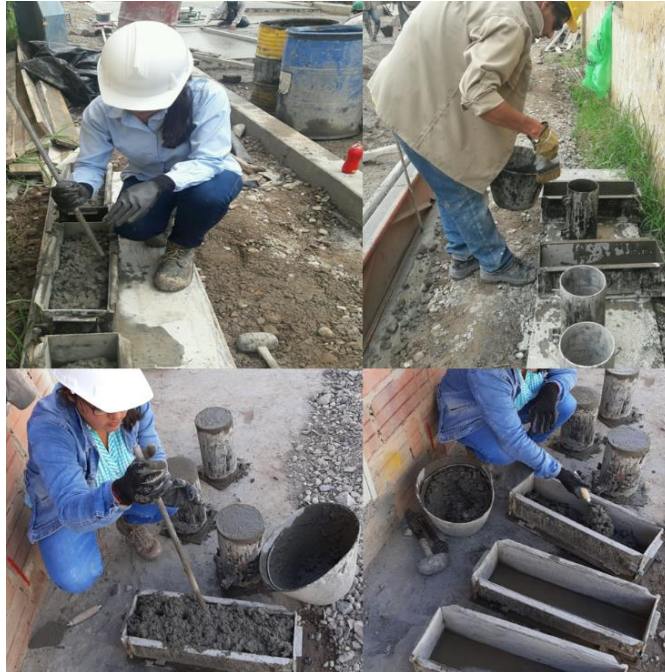
FOTOGRAFÍA 26 Elaboración de Muestras de Viguetas en Concreto
