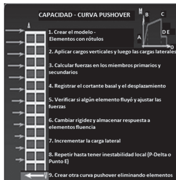
Fig. 11. Método de pushover. Fuente: Molinares, 1996.
