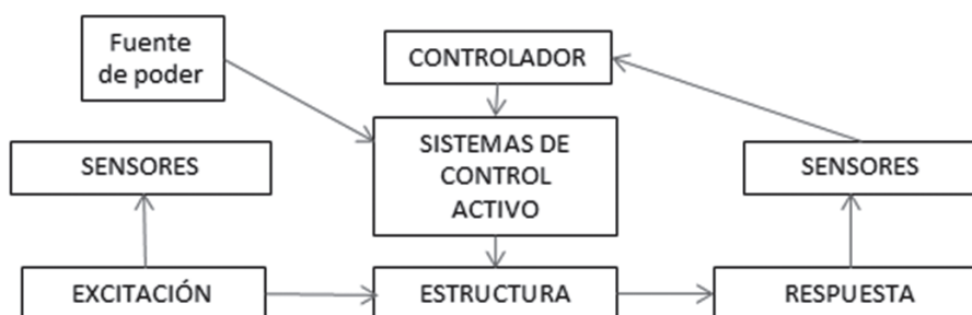
Fig. 2. Sistema de control activo.
