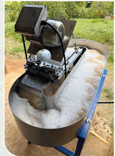
Pulpeo de fibras de fique en pila holandesa (2025)
