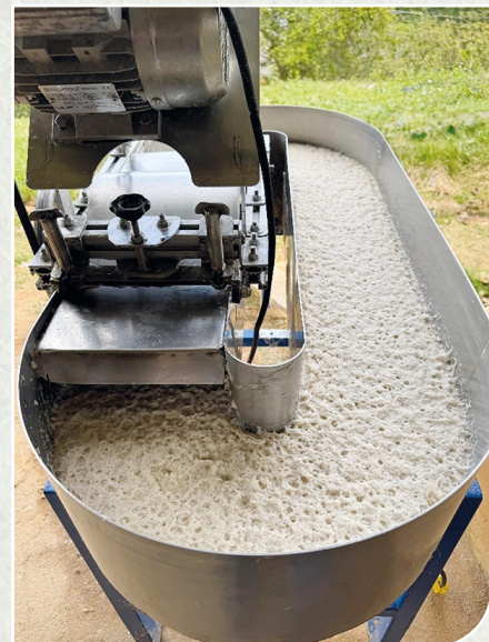
Pila holandesa al final del pulpeo de fibras de fique (2025)
