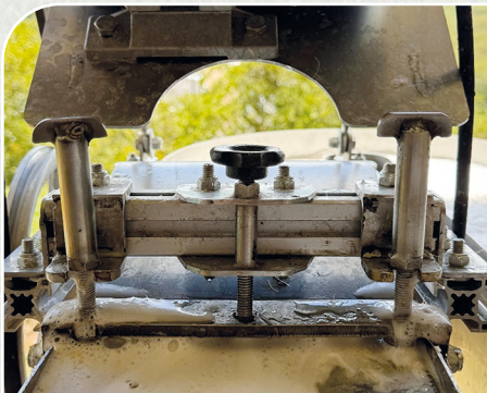
Detalle de tornillo central y tornillos de soporte (2025)
