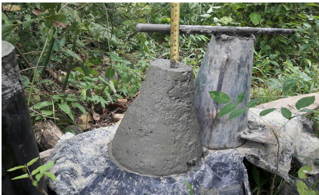
Imagen 21. Asentamiento de 3" arrojado de las muestras del concreto, se obtuvieron por cada torre 7 ejemplares.
