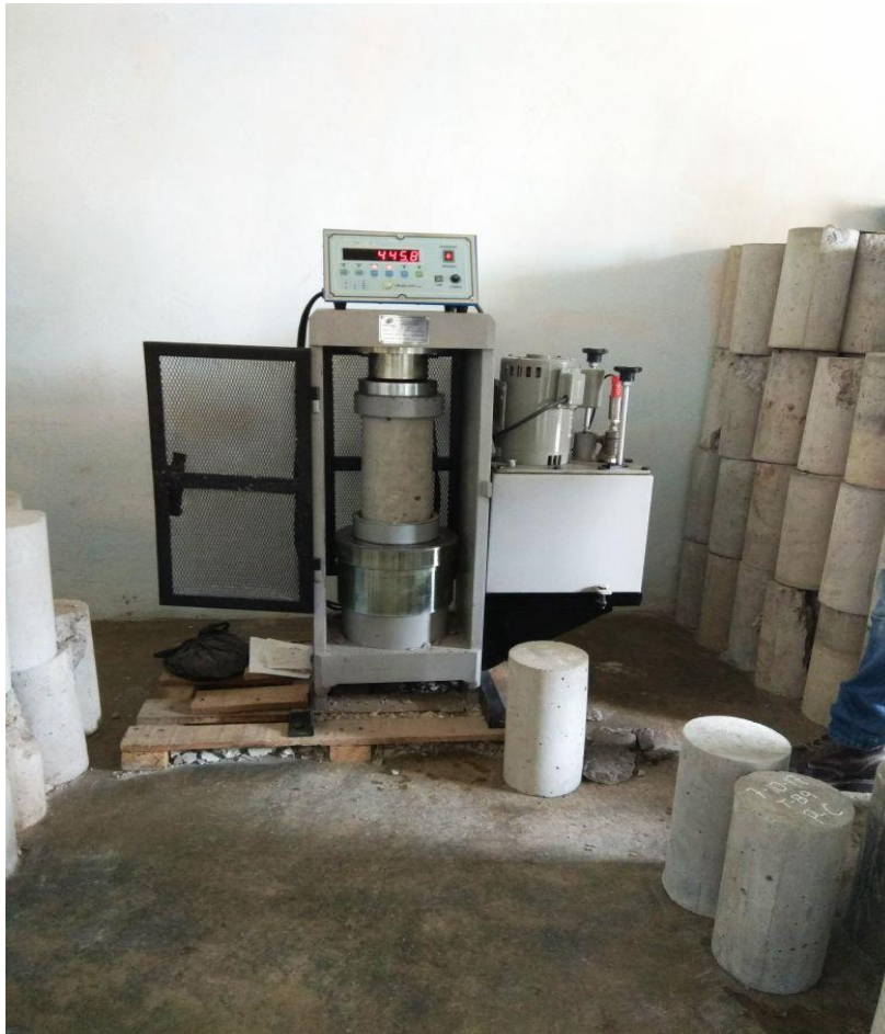
Imagen 22. Falla de cilindros de la torre 89 a los 14 días, en la cual se obtuvo un resultado de 445.8 * 8.17 = 3642.18 psi.
