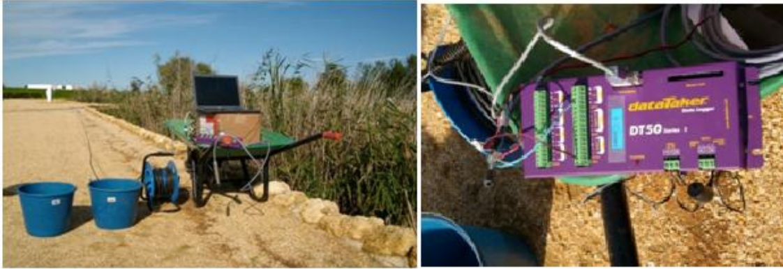
FIGURA 14. Equipo de medición de conductividad hidráulica.
