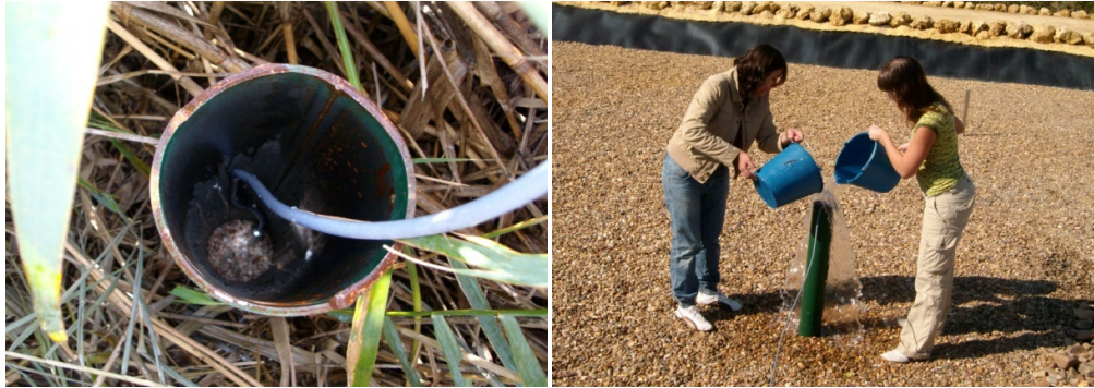
FIGURA 13. Tubo de medición conductividad hidráulica.
