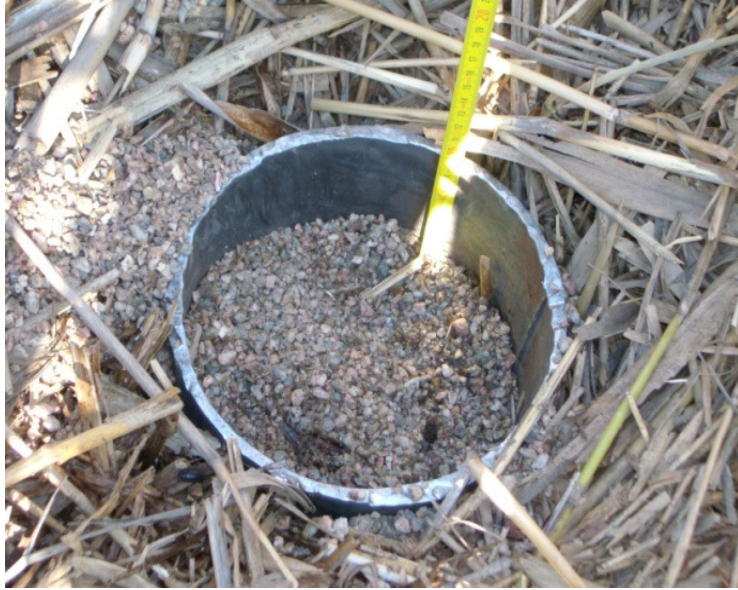
FIGURA 19. Punto de muestreo ensayo de sólidos acumulados.
