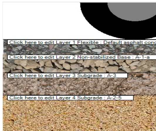
Imagen 1. Estructura de un pavimento
