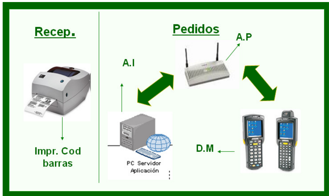
Figura 30. Esquema de funcionamiento de la solución de automatización del picking
