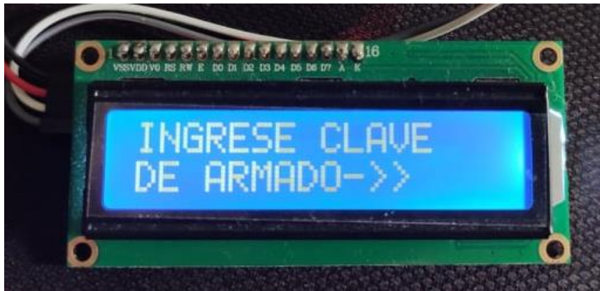
Figura 16. Ingreso de clave para estado de armado del sistema Fuente: El autor. 2020
