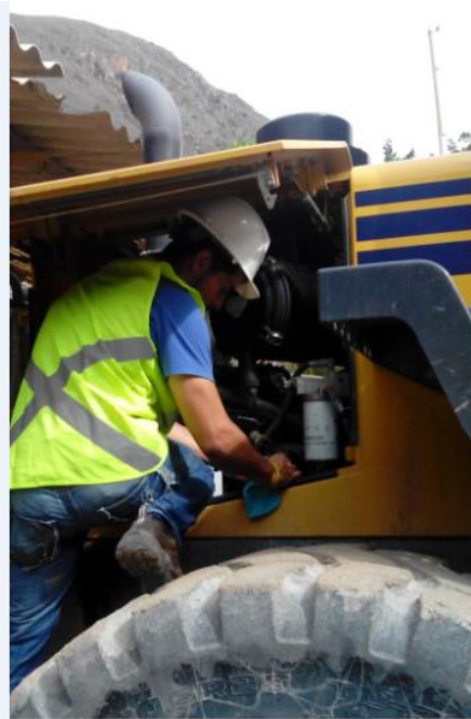
Figura 44. Cambio de Aceite y Filtros
