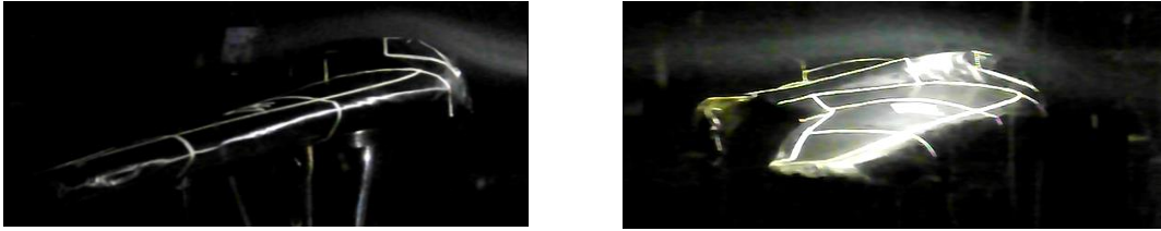
Figura 25. Pruebas en túnel de viento del modelo, con ráfagas de humo.
