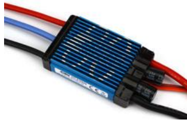
Figura 21. Variador de velocidad speed controller: 80-Amp Pro Switch-Mode BEC Brushless ESC, EC5 (V2) [10].
