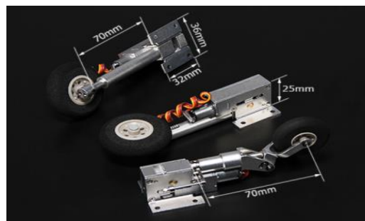
Figura 23. Tren de aterrizaje retráctil marca y modelo: Turnigy Full Metal Servoless Retracts with Oleo Legs (45mm) (Tricycle, Habu type) [10].
