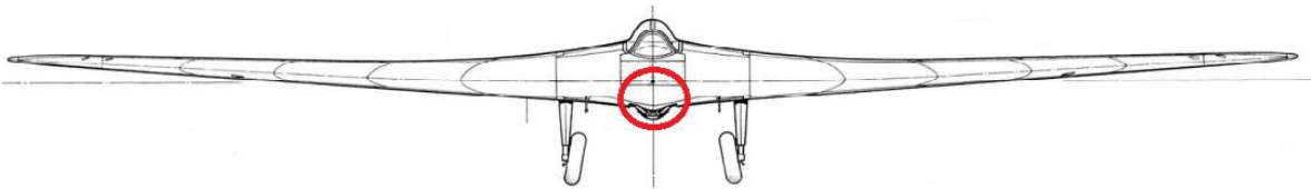
Figura 4. Vista frontal del modelo planeador Horten IX V1 [6], el círculo rojo muestra la sección en la cual se incorporará el casing del motor fan de la figura 2, en el nuevo prototipo.
