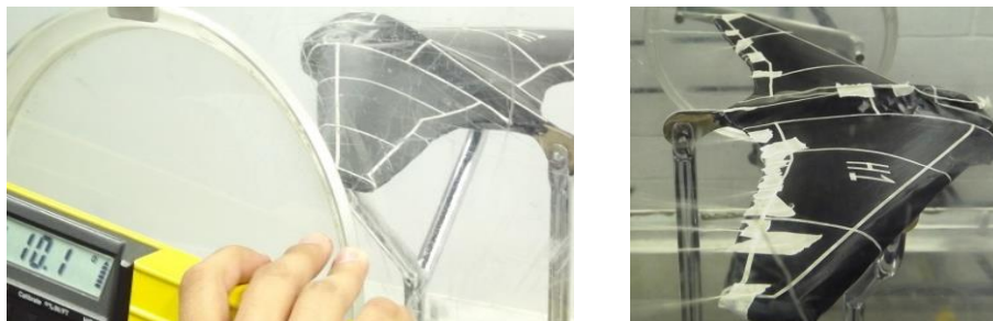
Figura 24. Pruebas modelo físico en túnel de viento. Izquierda: \alpha = 10^\circ . Derecha: Hilos adheridos que visualizan la formación de vórtices.
