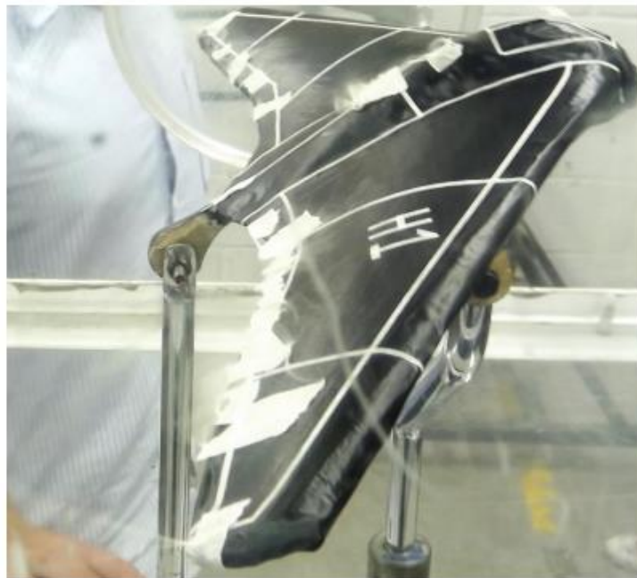
Foto No. 4. Ala volante a 20 m/s y \alpha = 12^\circ . Hay vórtices de gran magnitud en las puntas del ala.
