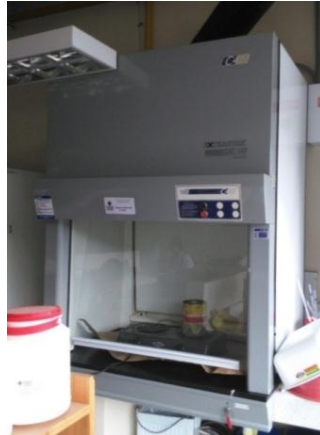
Figura 19. Cabina extractora de gases materiales
