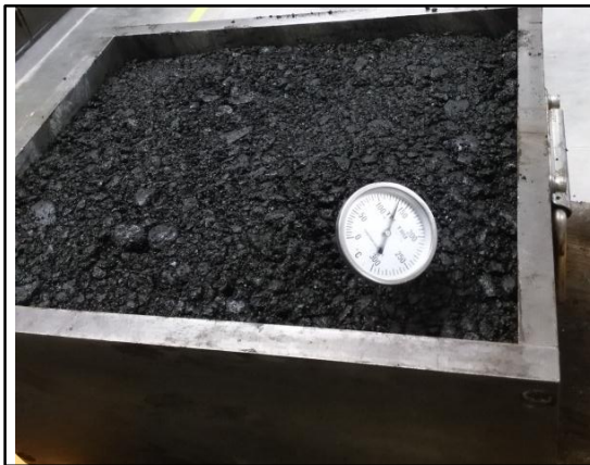
Figura 36. Mezcla homogénea en caliente para realizar ensayo Roller Compacter
