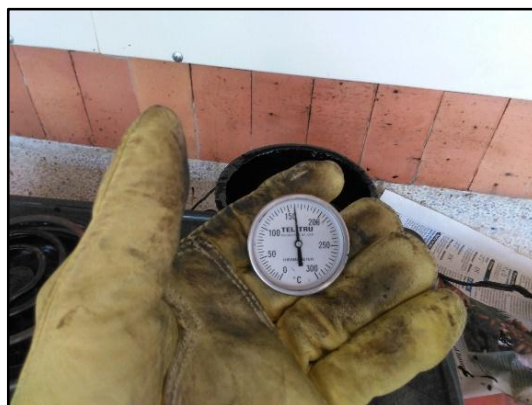
Figura 28. Proceso de calentamiento la mezcla asfáltica
