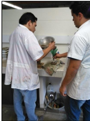
Figura 15. Llenado del agregado fino Saturado al picnómetro
