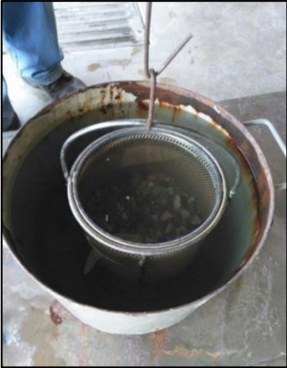
Figura 11. Periodo de inmersión del agregado grueso
