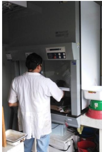
Figura 20: Incorporación del material PVC (molido) al material bituminoso.
