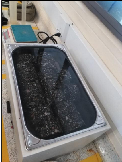
Figura 34. Periodo de baño De agua maría de las briquetas
