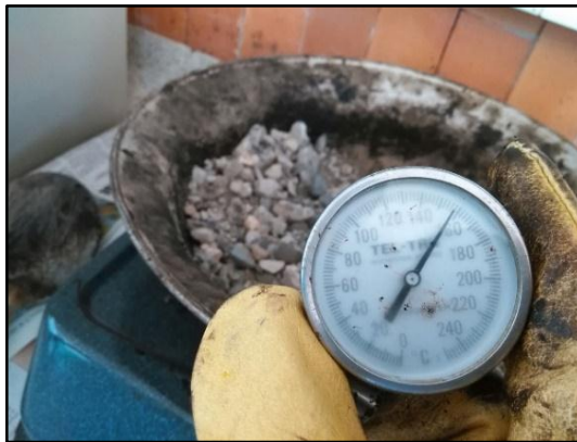
Figura 27. Proceso de calentamiento de los agregados pétreos
