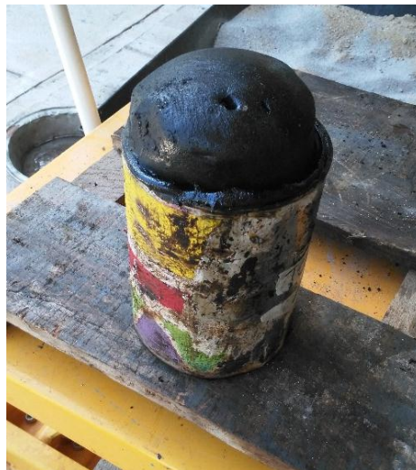
Figura 40. Reaccion del asfalto modificado con PVC
