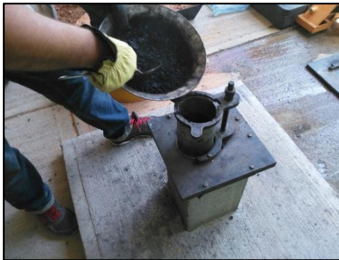
Figura 30. Adecuación de la mezcla en el molde De compactación
