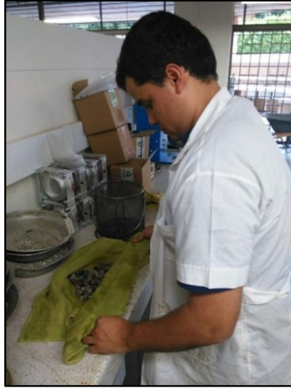
Figura 12. Proceso de secado superficial de las partículas gruesas
