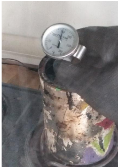
Figura 22. Control de temperatura del mezclado.
