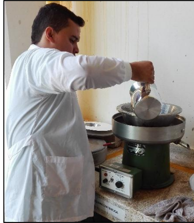
Figura 25. Cubrimiento de la porción con el solvente.
